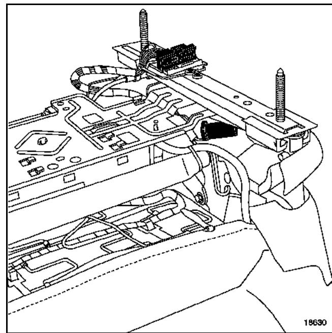
**ВАЖНОЕ ЗАМЕЧАНИЕ:** перед установкой сиденья проверьте внешнее состояние разъемов на каркасе сиденья и на кузове
