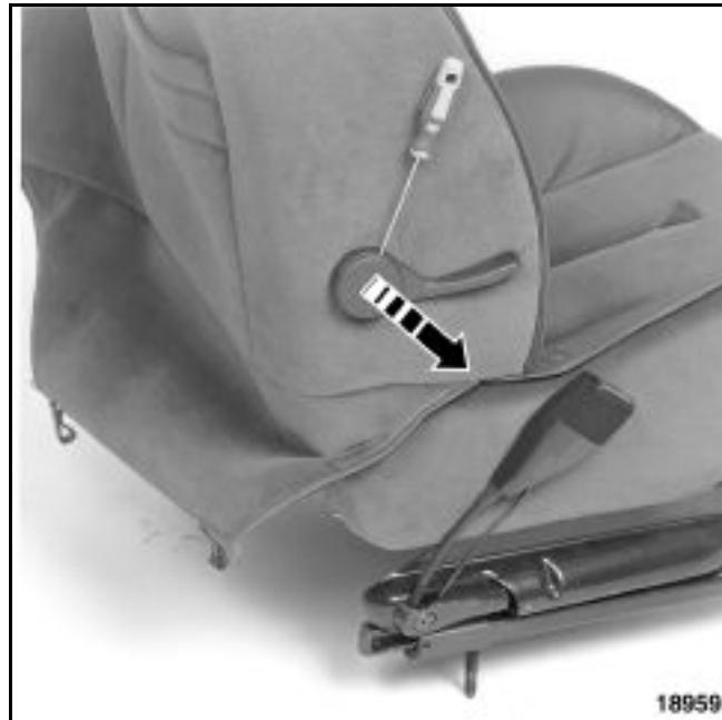
Снимите заглушку, затем ручку регулировки поясничного подпора.
