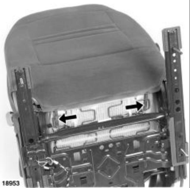
снимите два упругих элемента фиксации чехла спинки сиденья.
