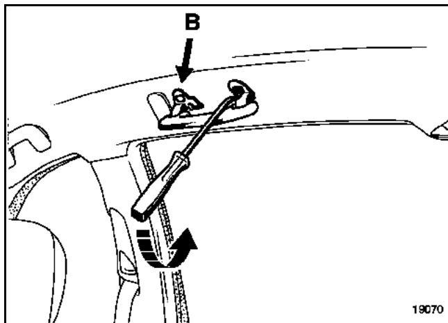
При помощи приспособления (Car. 1597) отсоедините фиксаторы поручней (B).
