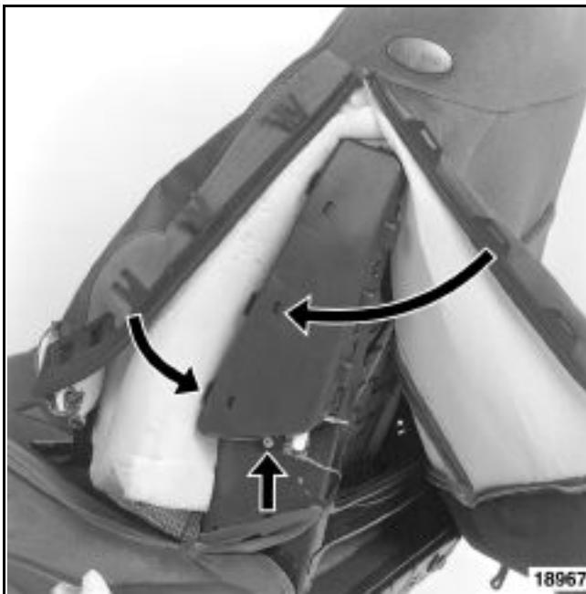
Отсоедините фиксаторы крепления чехла на кассете подушки безопасности, затем поднимите ее частично в задней части.
