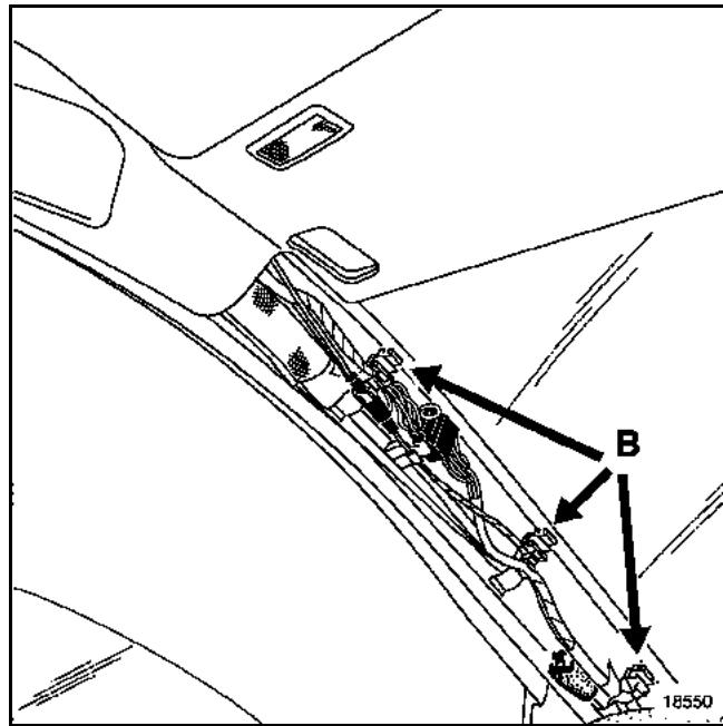
Проверьте, хорошо ли защелкиваются фиксаторы. Установите фиксаторы в точки (B), а затем пристегните облицовку.
