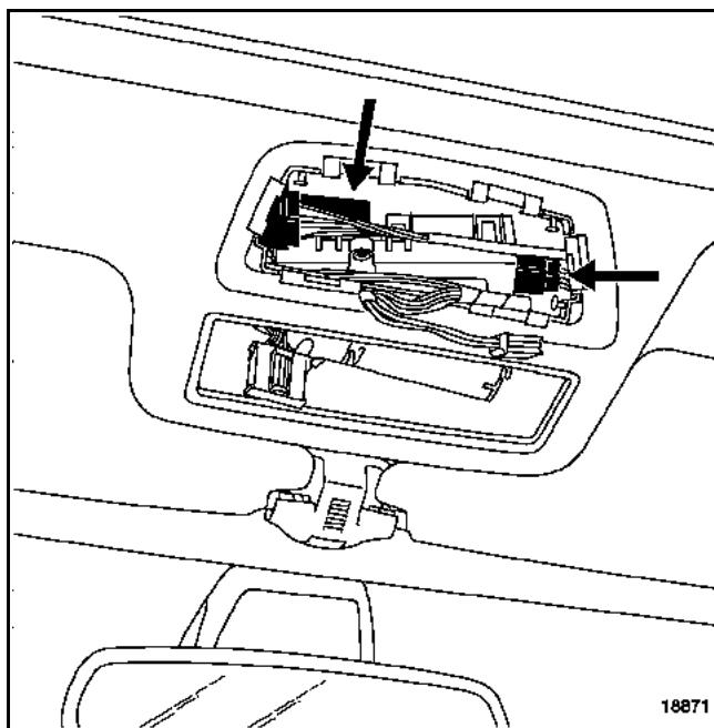
Разъедините два разъема электродвигателя привода люка крыши (если он есть)
