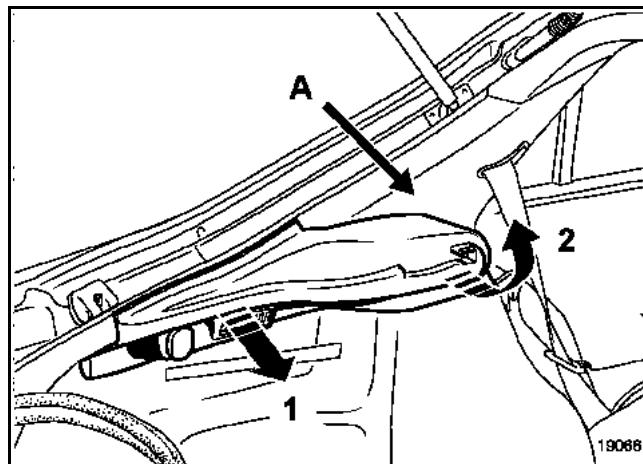
снимите задний уплотнитель багажного отделения.
