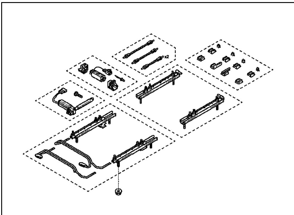
**СНЯТИЕ: Салазки с ручной регулировкой**
