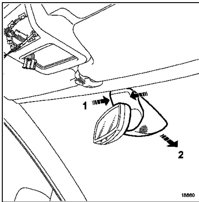
Снимите облицовку внутреннего зеркала заднего вида, нажав на верхнюю часть корпуса (1) и одновременно потянув за нижнюю часть корпуса зеркала (2).
