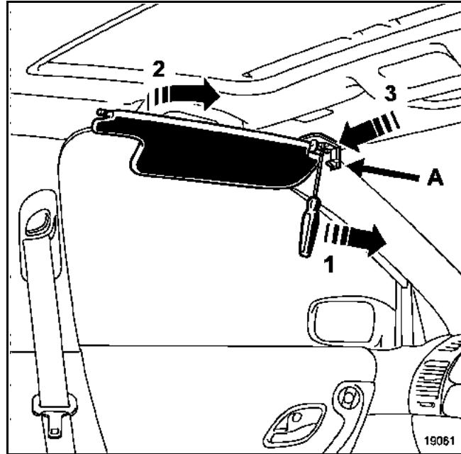
Отсоедините от фиксаторов крышку крепления (A)
