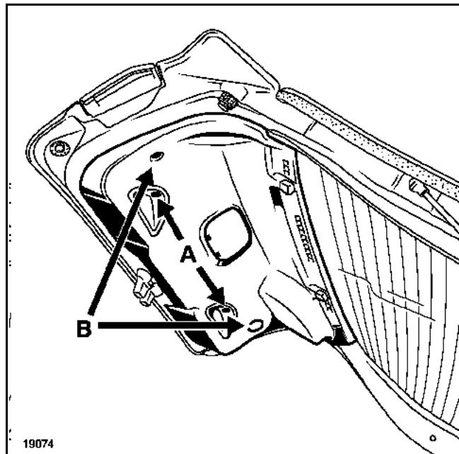
Снимите крепежные болты (A), затем отсоедините обивку (3).
