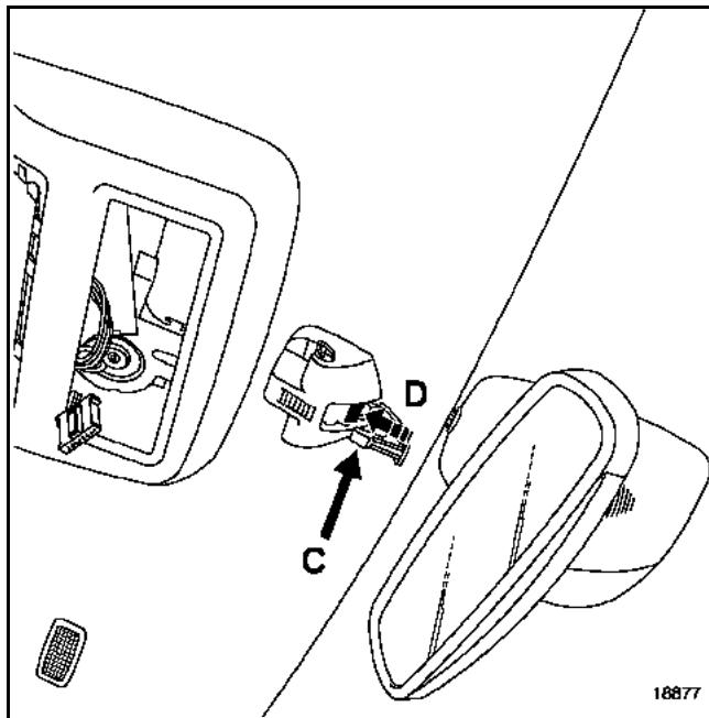
Отсоедините крышку винта крепления (C).
