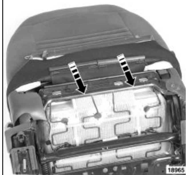
Снимите удерживающие ленты сзади чехла спинки сиденья. Отсоедините держатели чехла на кассете подушки безопасности, затем поднимите ее частично в задней части.
