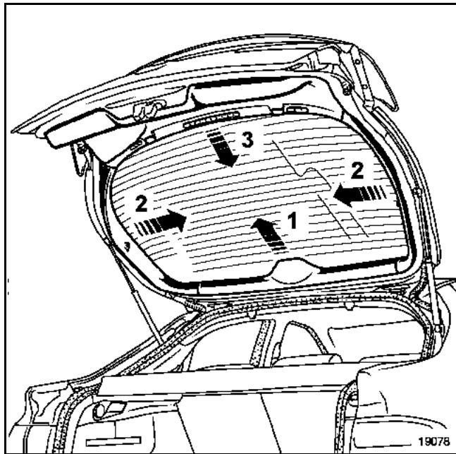
При помощи щипцов для снятия держателей обивок и облицовок снимите облицовки проема заднего стекла, сначала облицовку (1), затем облицовки (2).
