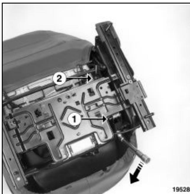
вставьте торцовый трубчатый ключ на 17 между каркасом сиденья и каркасом салазок и, действуя ключом как рычагом, снимите ось крепления (1).
