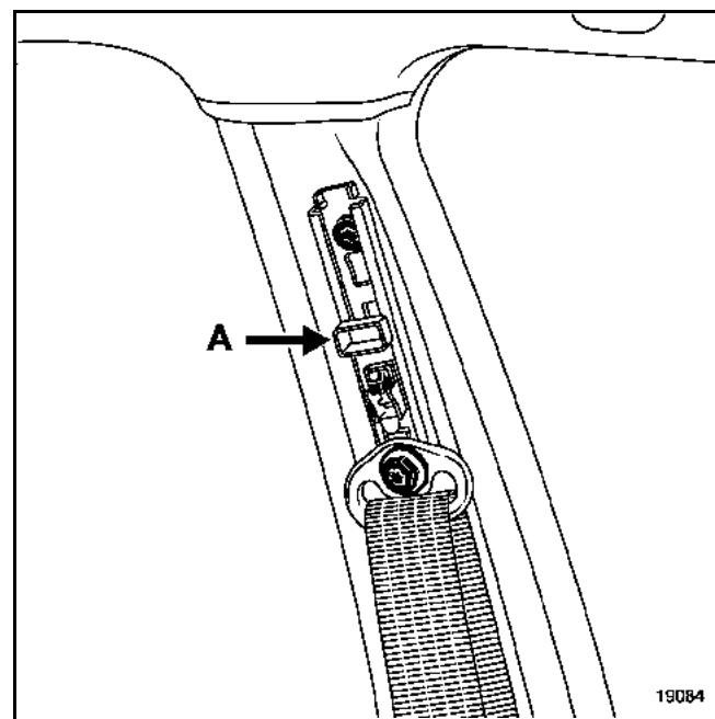
Установите в нижнее положение пластинку регулировки ремня безопасности по высоте.
