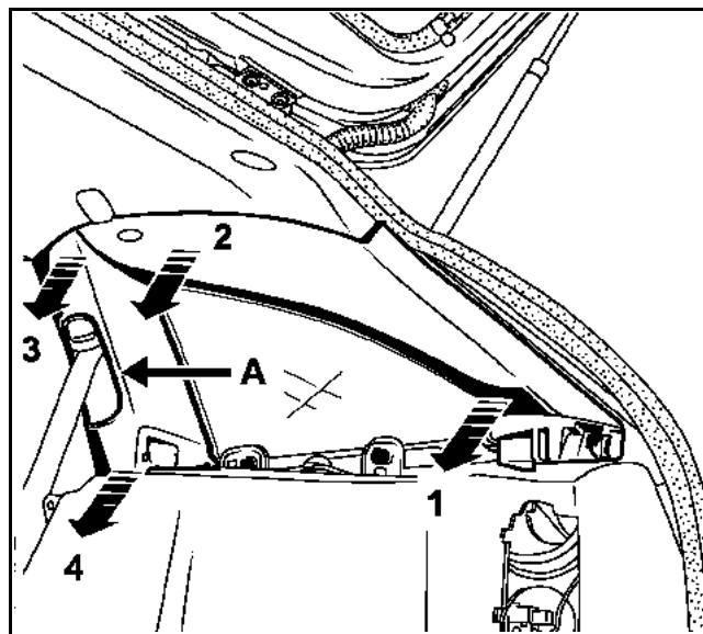
отсоедините от фиксаторов облицовку (1), (2), (3), а затем (4).
