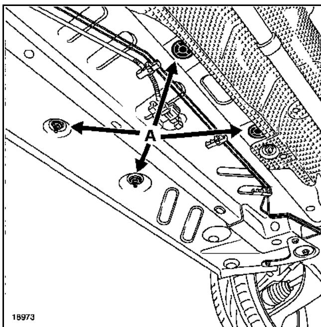
Снимите заглушки и четыре крепежных гайки под днищем кузова (A).
