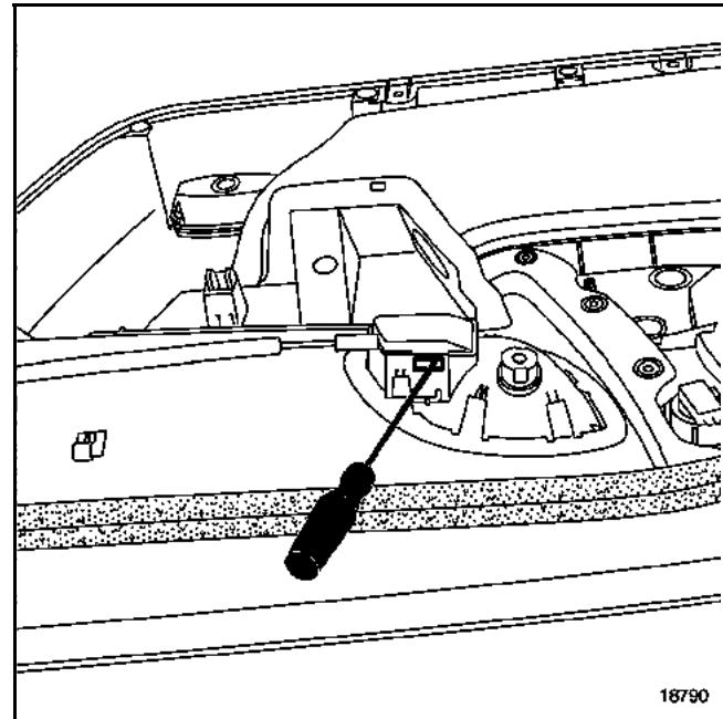
При помощи небольшой плоской отвертки отсоедините крышку крепления троса привода внутренней ручки двери.
