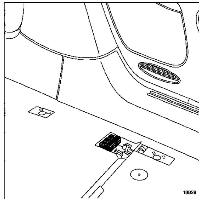
Момент затяжки крепежных гаек переднего сиденья **44 Н.м.**
