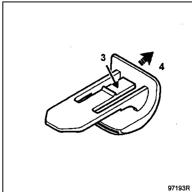
Отожмите два пружинных фиксатора, расположенных с задней части обивки крыши кабины, сначала нажав на (3), затем переместив в направлении (4).
