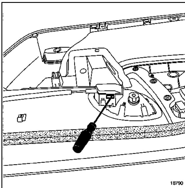
При помощи плоской отвертки отсоедините от фиксаторов крышку крепления троса привода внутренней ручки двери.
