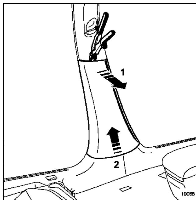
Снимите облицовку от фиксаторов в верхней части (1).
