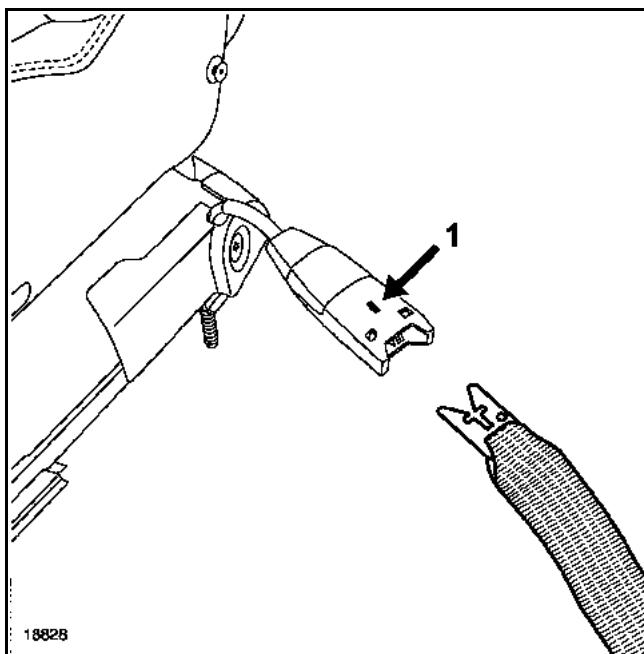
Отсоедините ремень безопасности, нажав на фиксатор (1).
