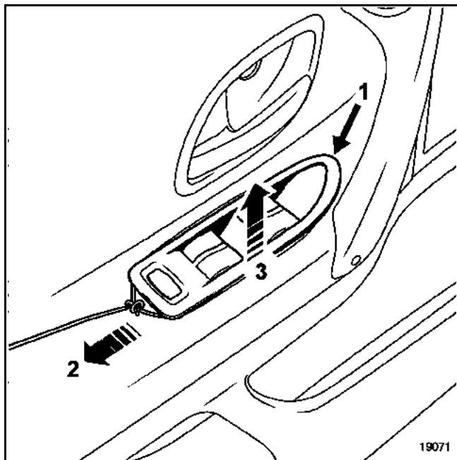
Сделайте скользящий узел на конце электропровода диаметром вместе с оболочкой (**3 мм**), затем проденьте другой конец провода в узел.
