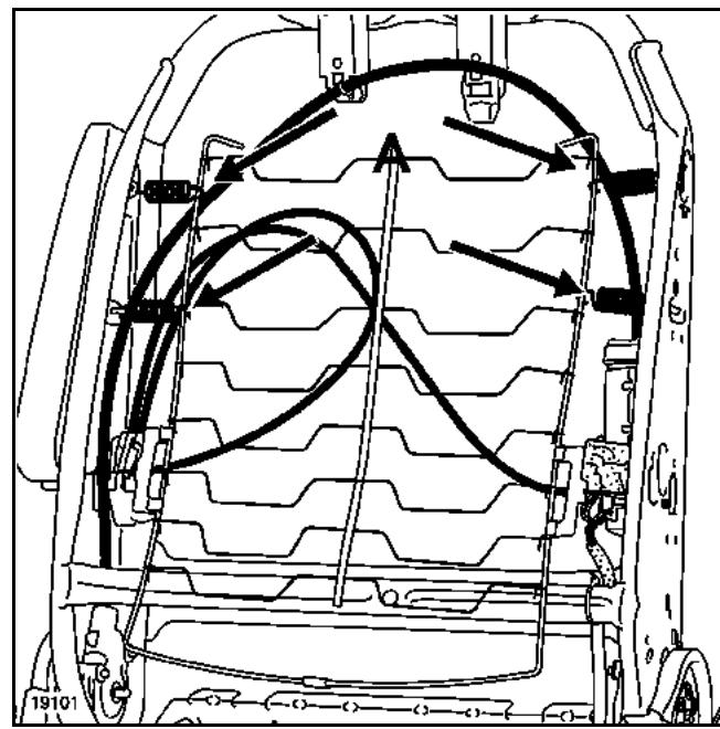
Разрежьте четыре задних оттяжных пружины, зафиксированных на проволочном каркасе в точках (A).
