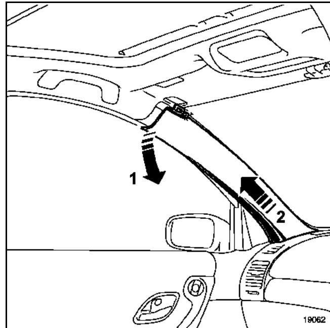
Частично снимите уплотнитель дверного проема. Отсоедините облицовку от фиксаторов в верхней части (1).
