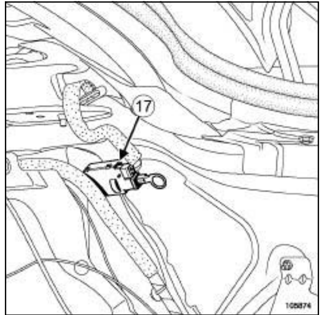
17 - Электродвигатель замка крышки люка наливной горловины топливного бака (К, Е, L)
