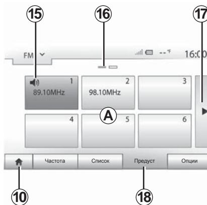
Названия радиостанций, частота которых не используется системой RDS, на экране не отображаются. Они сортируются по частоте, которая указывается в конце списка.
