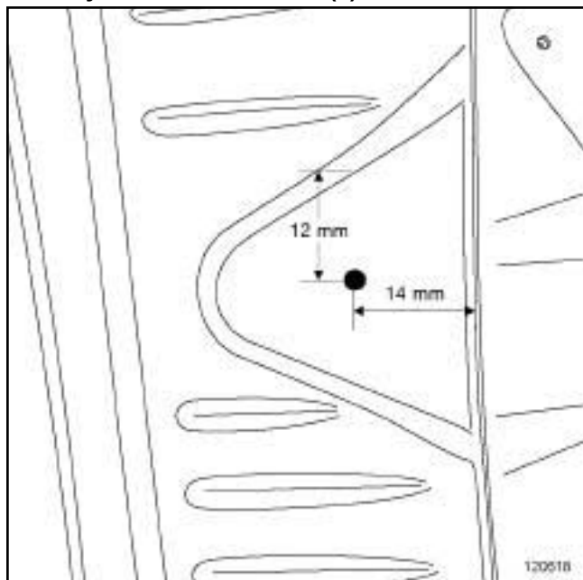
Схема установки шпильки (2)
