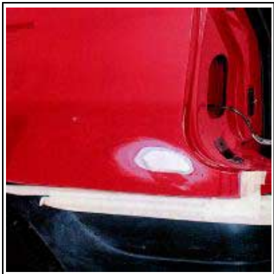
Нанесение полиэфирного грунта
