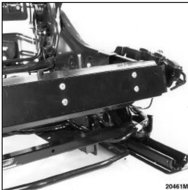
Отсоедините трос, потянув его по оси с помощью щипцов со стороны двигателя.
