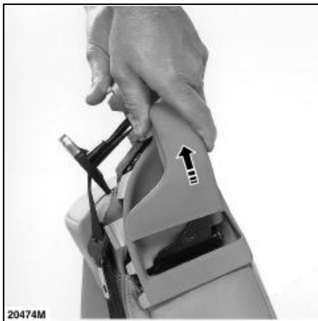
Снимите заднюю секцию крышки перекладки.
