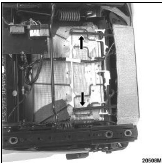
Снимите ручку регулировки наклона спинки сиденья изнутри, для этого разведите щели ручки с помощью отвертки, затем потяните ручку вверх.
