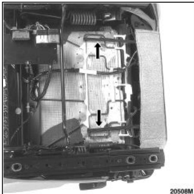
Снимите заднюю секцию спинки сиденья, потянув ее вверх, чтобы освободить выступы.
