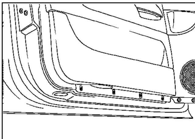
Потяните обивку на себя, чтобы отсоединить фиксаторы, затем потяните ее вверх.
