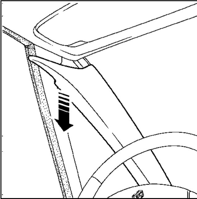
Разъедините разъем жгута проводов крыши.
