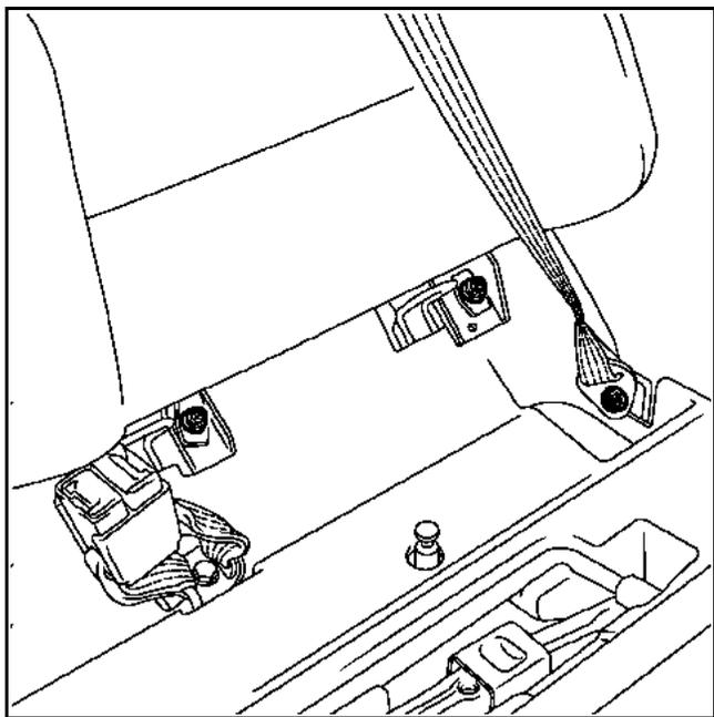
Сдвиньте подушки сиденья и снимите четыре гайки крепления спинки сиденья.
