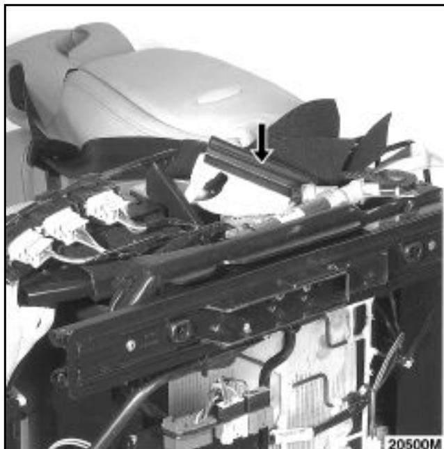
Освободите упругие крепежные элементы обивки спинки сиденья, отрезав двойные фиксаторы.
