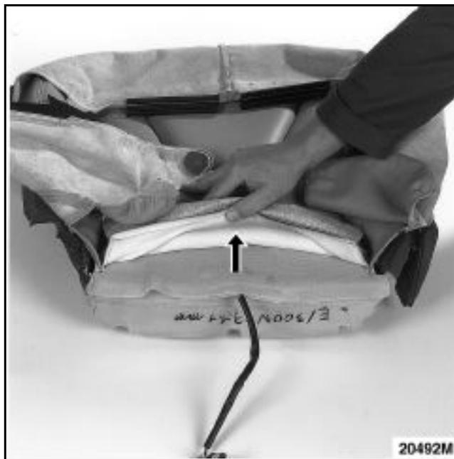
Снимите упругие крепежные элементы кармана.
