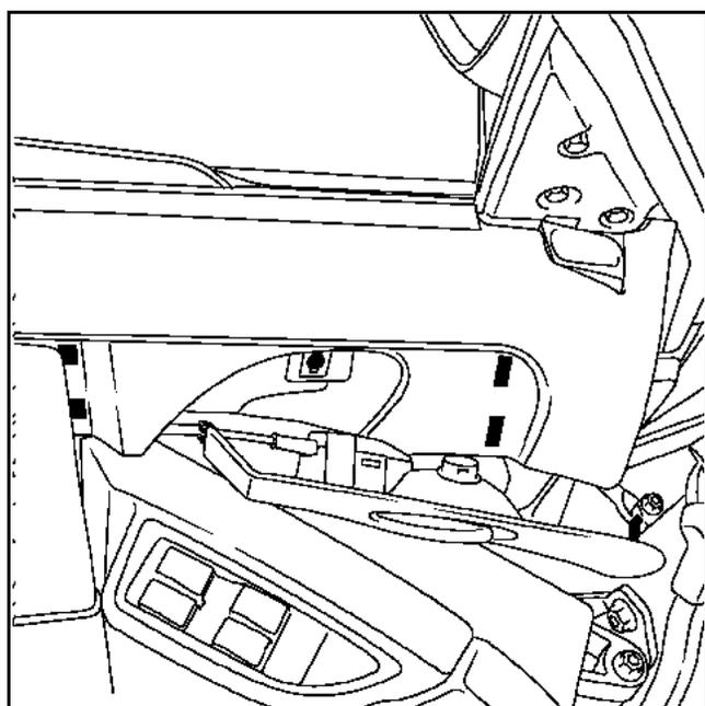
Снимите четыре болта нижнего крепления.
