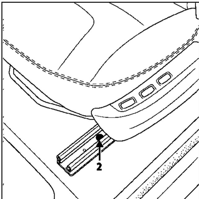
Сдвиньте сиденье насколько возможно вперед и отверните два задних болта крепления салазок.
