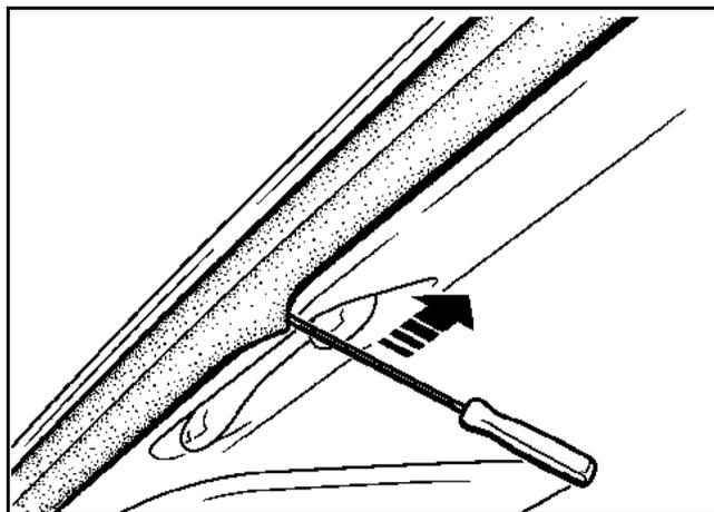
Установите на место уплотнители с помощью тонкой отвертки.
