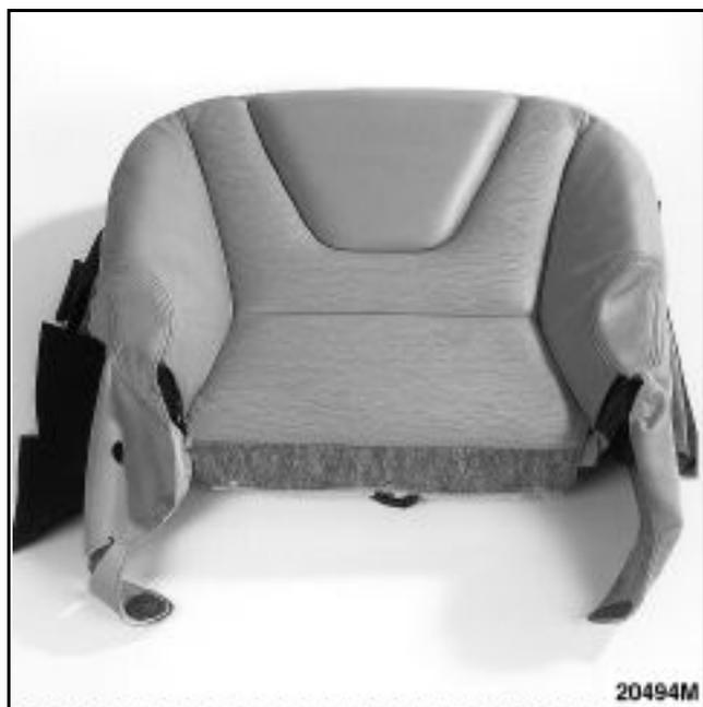
Отделите обивку от набивки из пеноматериала, для этого отведите обивку в сторону, затем отрежьте двойные фиксаторы в местах соединения с отбортовкой.
