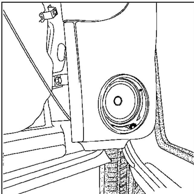
Потяните обивку на себя, чтобы отсоединить два фиксатора.
