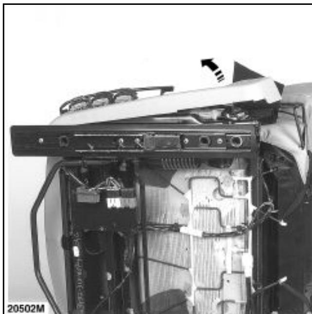
Снимите два фиксатора облицовки.
