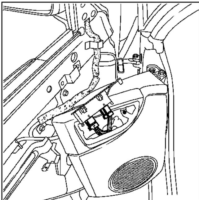
Снимите болт крепления громкоговорителя, повернув его на четверть оборота.
