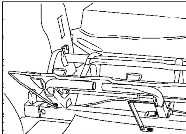
Снимите четыре болта заднего крепления.
