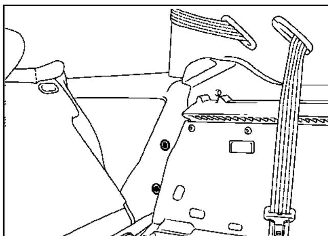
Слегка потяните переднюю часть панели к внутренней части автомобиля, чтобы освободить ее от уплотнителей и отсоединить два фиксатора.
