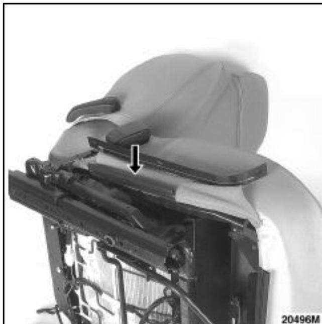
Разъедините два разъема и отрежьте пластмассовый хомут.
