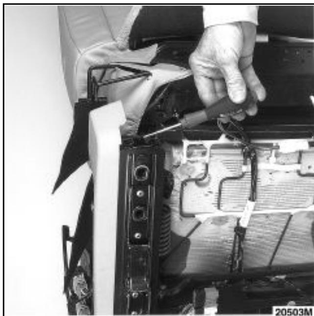
Поднимите заднюю часть крышки и потяните ее вверх.
