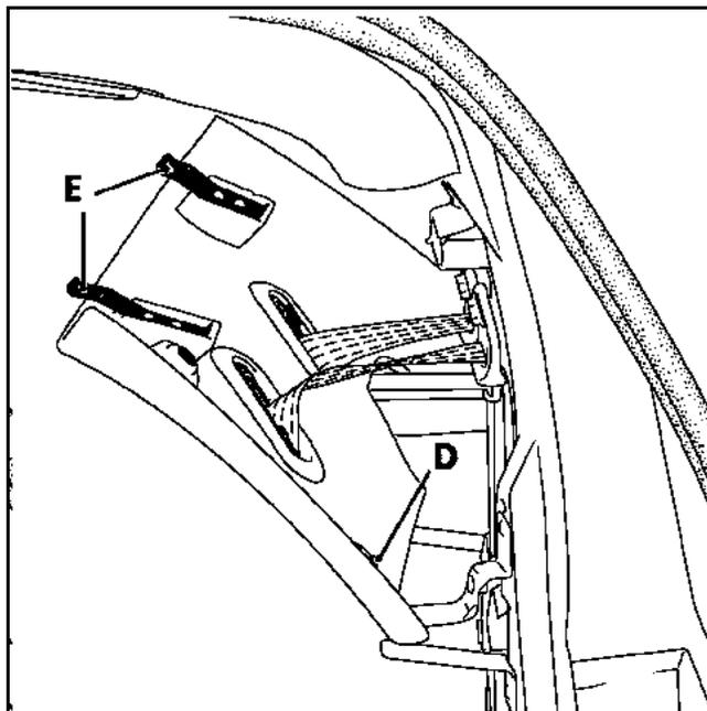
Снимите фиксированную ветвь ремня.
