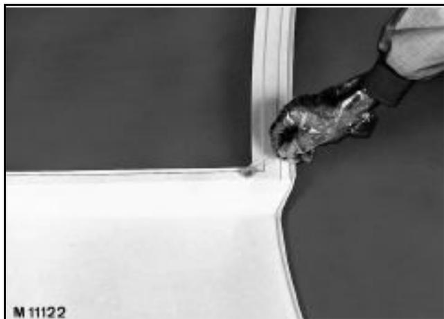
Нанесите тонкий однородный слой грунта (2) с помощью аппликатора (5). Ширина слоя 50 мм.
