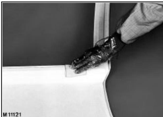
Нанесите бесцветный обезжиривающий состав (3) с помощью специальной бумаги (6) слоем шириной 50 мм.
