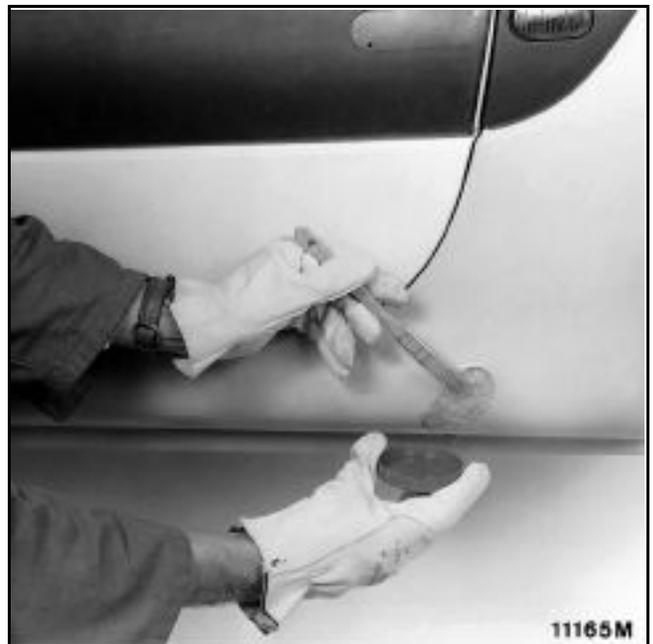
Наложите ранее вырезанную заплату и пропитайте ее смесью эпоксидной смолы с помощью кисти, удаляя пузырьки (для ремонта отверстий и сквозных трещин).
