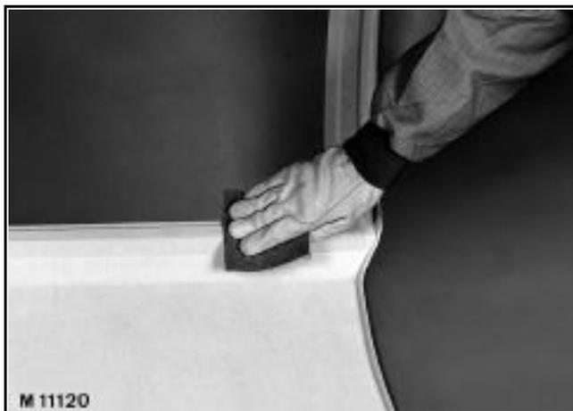
С помощью шлифовальной шкурки (8) зачистите ремонтируемый участок по периметру на ширину 50 мм на склеиваемые поверхности (подробные сведения см. в соответствующих главах).
