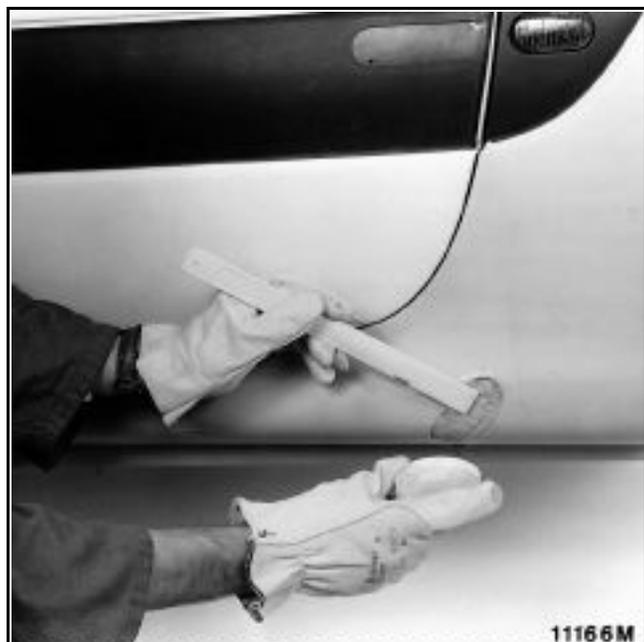
Нанесите по периметру смесь смолы с наполнителем из коротких полосок, удаляя пузырьки.
