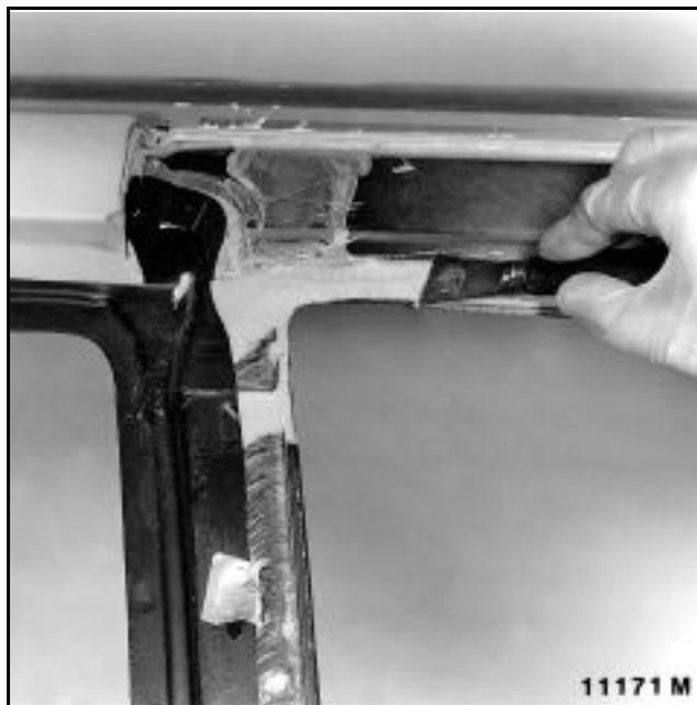
С помощью заостренного шпателя удалите верхнюю часть старого клея, оставив слой толщиной **1 - 2 мм**.
