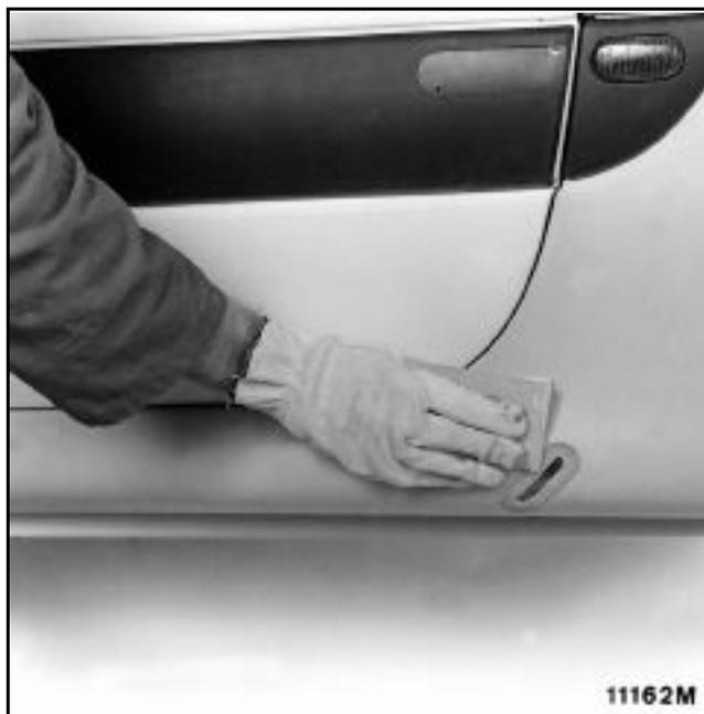
Зачистите вручную (с использованием шкурки P120) на ремонтируемые поверхности, чтобы удалить компоненты структуры панели, которые выходят на поверхность от нагрева при использовании шлифовальной машинки.
