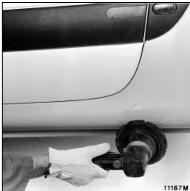
Обработайте полиэфирной мастикой ремонтируемый участок, в особенности небольшие каверны в слое эпоксидной смолы.
