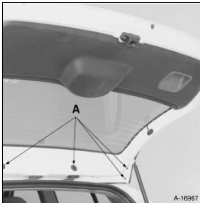
Снимите болты крепления (A) спойлера на двери задка.
