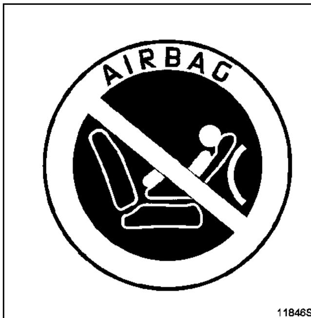
После замены приборной панели автомобиля с подушкой безопасности пассажира необходимо приклеить на приборной панели предупреждающую этикетку. Этикетка входит в состав **складского комплекта**, складской номер **77 01 205 442**.
