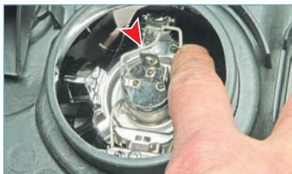
...выводим его из зацепления с крючком отражателя.
