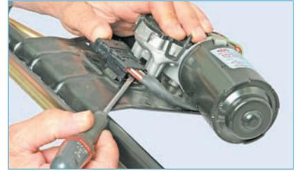
Отжав отверткой фиксатор колодки проводов...
