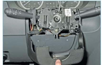
Снимаем нижний кожух рулевой колонки.
