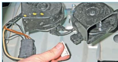
**Отсоединяем колодку проводов от звукового сигнала высокого тона.**
