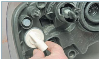
Поворачиваем патрон лампы по часовой стрелке (для правой фары — против часовой стрелки)...
