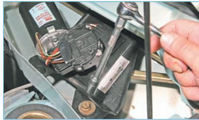
Головкой «на 10» отворачиваем болт крепления кронштейна очистителя.
