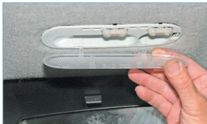
...снимаем рассеиватель плафона, преодолевая сопротивление четырех фиксаторов.
