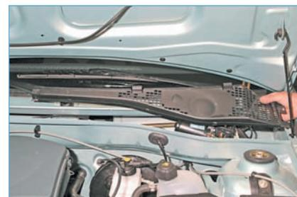
Снимаем левую накладку.
