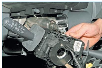
...сдвигаем соединитель с рулевой колонки.
