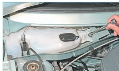
Головкой «на 10» отворачиваем болт крепления бачка омывателя...
