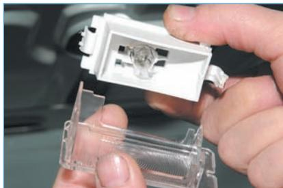
...и снимаем рассеиватель плафона.
