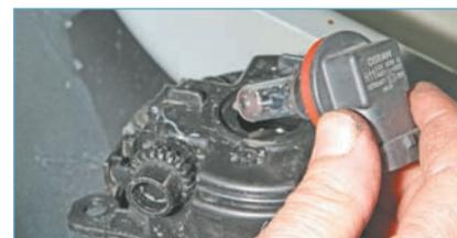
Поворачиваем против часовой стрелки и вынимаем лампу.
