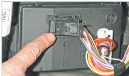
...и поворачивая скобу фиксатора, отсоединяем колодку жгута проводов от блока.
