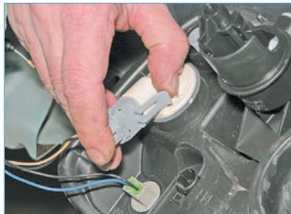
...отжимаем фиксатор колодки проводов...
