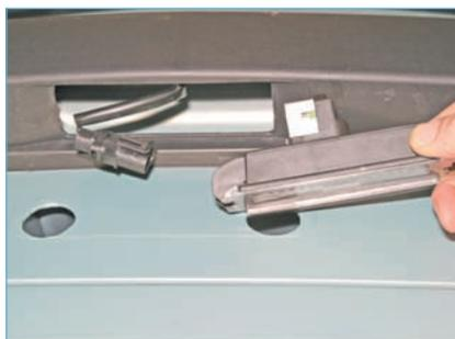
...отсоединяем колодку проводов от фонаря.
