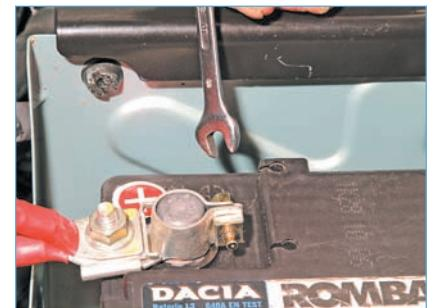
Ключом «на 8» ослабляем затяжку стяжного болта клеммы проводов на «плюсовом» выводе аккумуляторной батареи...
