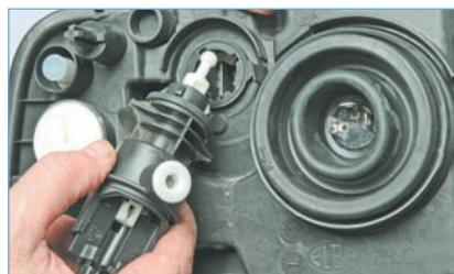
...и вынимаем исполнительный механизм регулятора из корпуса блок-фары.
