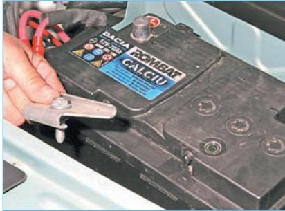
...и снимаем пластину с болтом.
