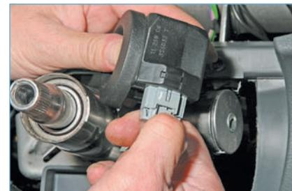
Нажав на фиксатор колодки проводов, отсоединяем ее от катушки иммобилайзера.
