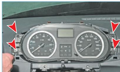
Ключом «Torx T-20» отворачиваем четыре самореза крепления комбинации приборов.
