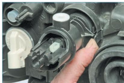
Отжав фиксатор на корпусе блок-фары...
