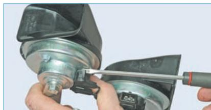
**Поддеваем отверткой фиксатор контактного разъема звукового сигнала низкого тона...**
