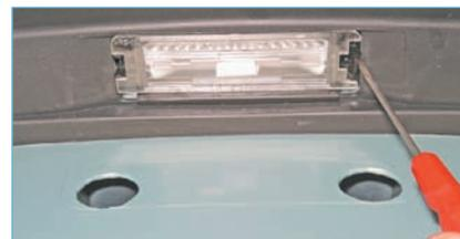
Отжимаем отверткой пластмассовый фиксатор фонаря...
