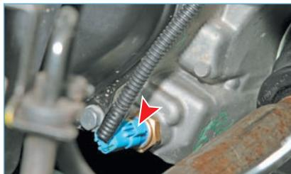
Отжав фиксатор колодки проводов... отсоединяем колодку от выключателя света заднего хода.
