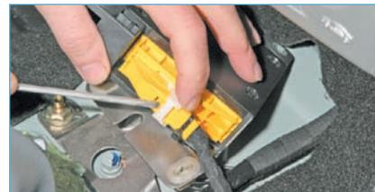
Нажав отверткой на фиксатор...
