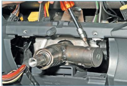
Ключом «Torx T-20» отворачиваем винт крепления выключателя зажигания.
