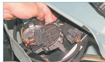
...отжав защелки крышки мотор-редуктора...
