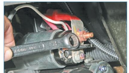
Накидным ключом «на 13» отворачиваем гайку крепления наконечника провода, соединенного с «плюсовым» выводом аккумуляторной батареи...
