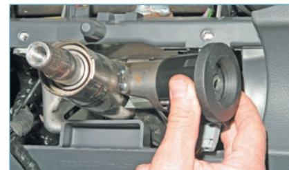
Отжав два пластмассовых фиксатора, снимаем катушку иммобилайзера (для наглядности подрулевые переключатели сняты).
