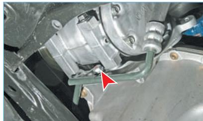
Головкой «на 13» отворачиваем болт крепления кронштейна трубки нагнетательной магистрали гидроусилителя рулевого управления к кронштейну двигателя.
