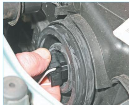
**Отсоединяем колодку проводов от лампы головного света.**
