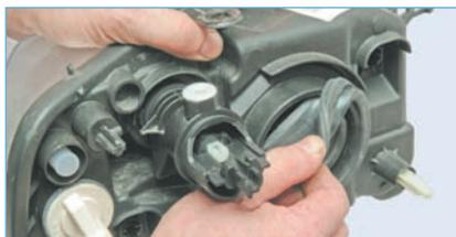
Снимаем резиновый уплотнительный чехол (для наглядности показано на снятой блок-фаре).
