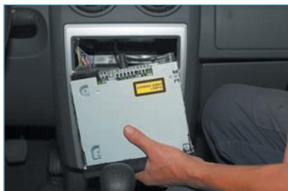
Вынимаем головное устройство системы звуковоспроизведения из гнезда центральной консоли.
