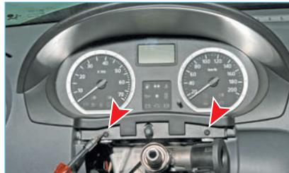
Ключом «Torx T-20» отворачиваем два самореза крепления декоративной накладки комбинации приборов (для наглядности подрулевые переключатели и рулевое колесо сняты).
