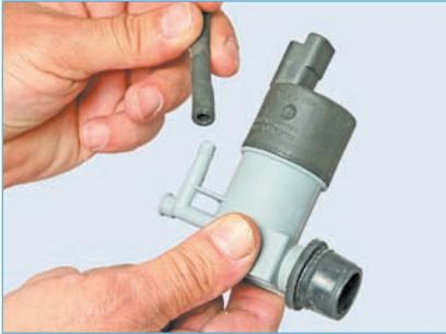
Снимаем шланг со штуцера насоса.
