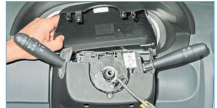
Снимаем верхний кожух рулевой колонки, преодолевая сопротивление двух фиксаторов.
