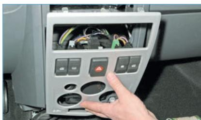
Снимаем накладку с консоли панели приборов.
