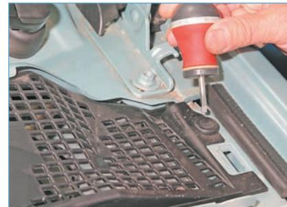
Поддеваем отверткой штифт пистона крепления левой накладки...
