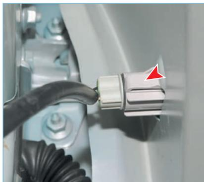
Боковой указатель поворота установлен в отверстии крыла кузова и крепится двумя фиксаторами (один фиксатор показан стрелкой, второй фиксатор, расположенный с противоположной стороны указателя, на фото не виден).
