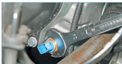
Ключом «на 24» выворачиваем выключатель света заднего хода.
