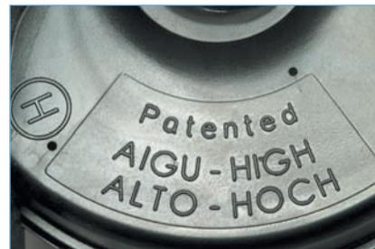
**Маркировка звукового сигнала высокого тона**
