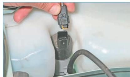
Отжав фиксатор, отсоединяем колодку проводов от насоса омывателя.
