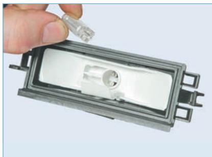
Вынимаем лампу из фонаря.
