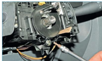
Ключом «Torx T-20» отворачиваем на несколько оборотов винт крепления соединителя.
