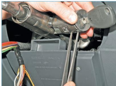
Установив ключ зажигания в положение между метками «А» и «М» (нанесенными на торце выключателя), пинцетом утапливаем два фиксатора выключателя...
