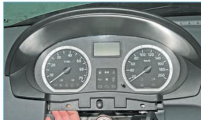
Оттягивая нижнюю часть накладки, освобождаем ее фиксаторы...
