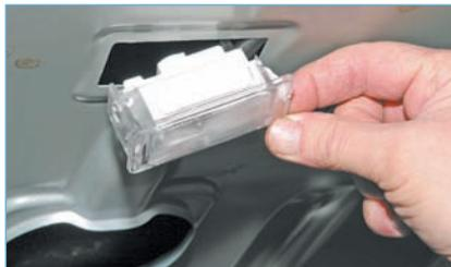
...и вынимаем его из отверстия в задней полке.
