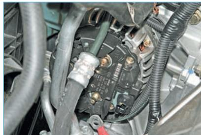
...и снимаем наконечник провода с вывода.
