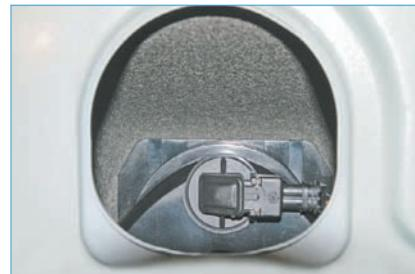
Внутри багажника, через отверстие в задней полке, поворачиваем против часовой стрелки патрон лампы...
