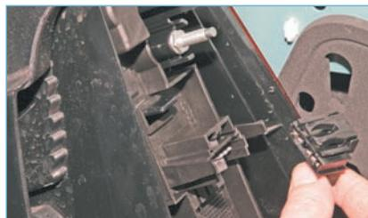
...отсоединяем колодку проводов от фонаря...
