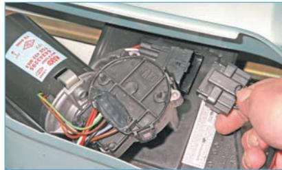
...отсоединяем колодку жгута проводов от колодки проводов мотор-редуктора.
