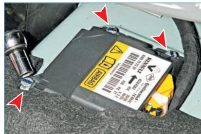
Головкой «на 10» отворачиваем три болта крепления блока управления подушками безопасности.
