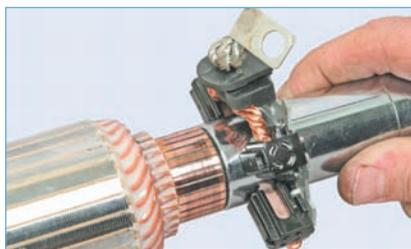
**Прижав оправку к коллектору, сдвигаем с нее щеточный узел на коллектор.**
