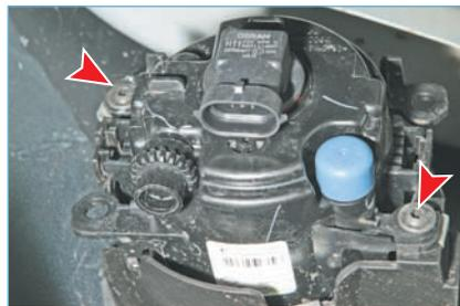
Ключом «Торх Т-20» отворачиваем два винта крепления фары к бамперу...
