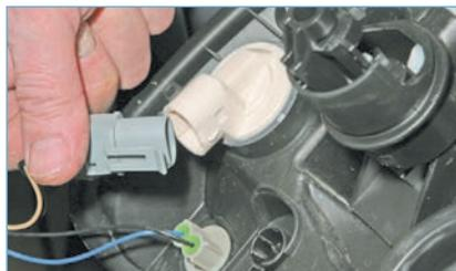
...и отсоединяем колодку от патрона лампы указателя поворота.
