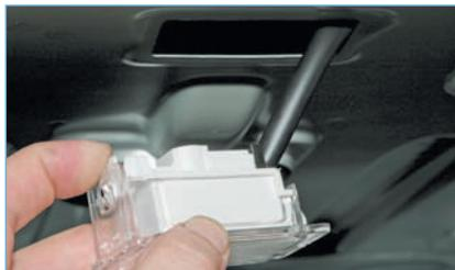
Отжимаем пластмассовый фиксатор...
