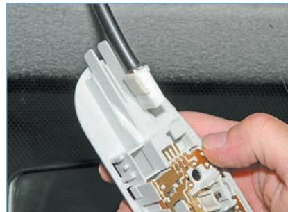
...и, отсоединив колодку проводов, снимаем плафон освещения салона.
