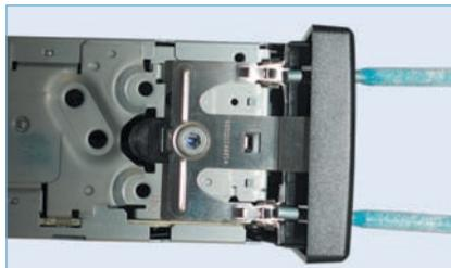
...вставляем в четыре боковых паза (по два с каждой стороны) устройства металлические стержни (можно использовать гвозди диаметром 2–3 мм) и одновременно надавливаем на них, сжимая четыре фиксатора (для наглядности показано на снятом головном устройстве).
