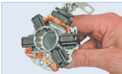
**...утапливаем щетки в направляющие и вставляем в центральное отверстие щеточного узла оправку.**
