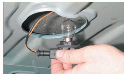
...и вынимаем патрон с лампой.
