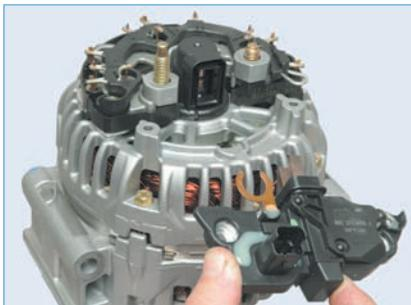
Снимаем щеткодержатель с регулятором напряжения.
