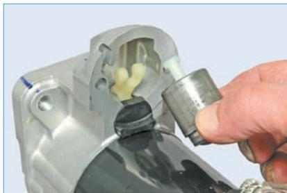
Снимаем якорь тягового реле. Для замены привода стартера...
