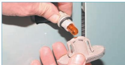
...вынимаем его из корпуса указателя.
