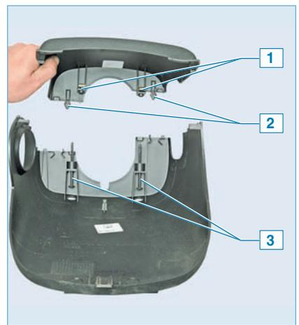
Элементы крепления кожухов рулевой колонки: 1 — пластинчатые гайки; 2 — фиксаторы; 3 — саморезы
