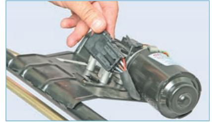
...выводим колодку проводов из направляющих кронштейна.
