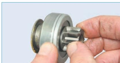
**...проворачиваем шестерню привода, удерживая муфту за наружную обойму.** Шестерня должна вращаться только в одном направлении. Зубья шестерни не должны иметь повреждений. В противном случае заменяем привод в сборе.
