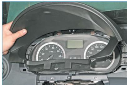
...и снимаем накладку.
