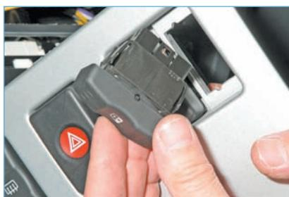
...и вынимаем выключатель из накладки.
