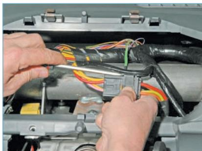
Поддев шлицевой отверткой фиксатор колодки жгута проводов, сдвигаем фиксатор...
