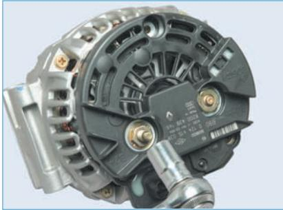
Головкой «на 13» отворачиваем две гайки...
