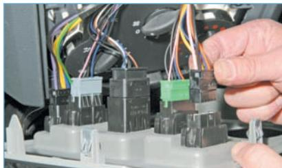
Отсоединяем колодку проводов от выключателя стеклоподъемника правой передней двери.
