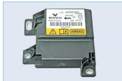
...и снимаем блок управления подушками безопасности.
