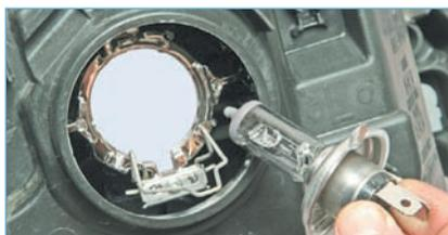
...и вынимаем лампу головного света из корпуса блок-фары.
