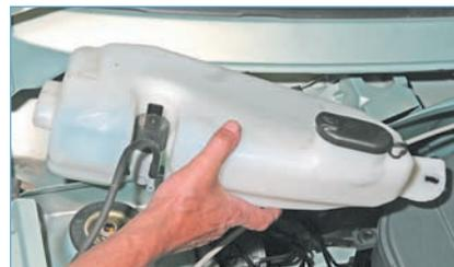
...и снимаем бачок омывателя с насосом в сборе.
