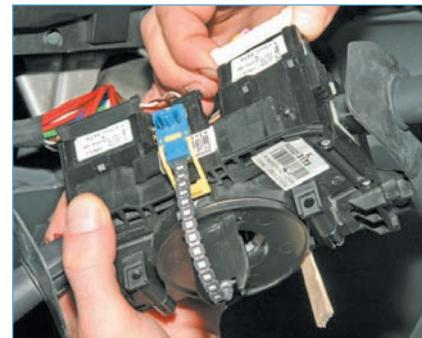
Отсоединяем две колодки жгутов проводов от подрулевых переключателей и одну колодку проводов от разъема на корпусе соединителя...
