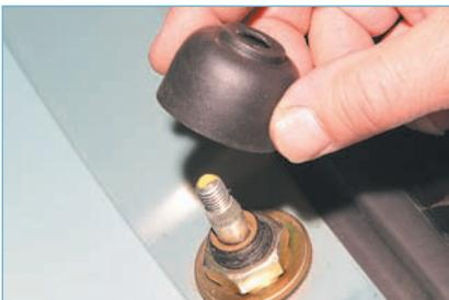
Снимаем с вала декоративный колпачок.
