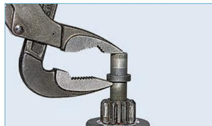
**Ограничительное кольцо хода шестерни привода надеваем на стопорное кольцо при помощи раздвижных пассатижей.**
