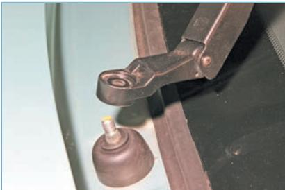
Снимаем с вала мотор-редуктора рычаг со щеткой.
