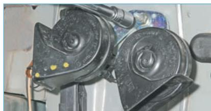
**Головкой «на 13» отворачиваем гайку крепления кронштейна звуковых сигналов...**
