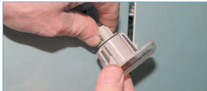
Повернув патрон с лампой против часовой стрелки...
