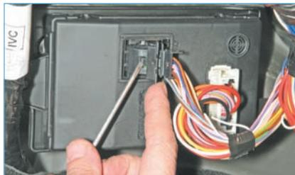
Нажав на фиксатор колодки жгута проводов...
