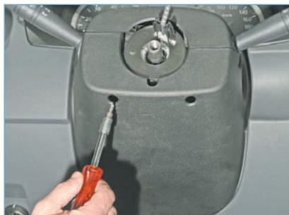
Ключом «Torx T-20» отворачиваем два самореза крепления кожухов рулевой колонки.
