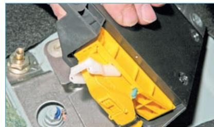
...и повернув запорную скобу колодки жгута проводов...
