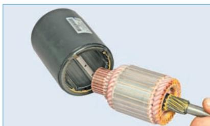
**Вынимаем якорь из статора.**
