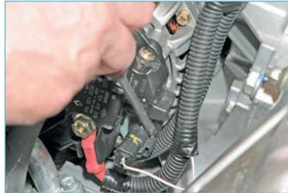
Нажав отверткой на фиксатор, отсоединяем колодку провода возбуждения от разъема генератора.
