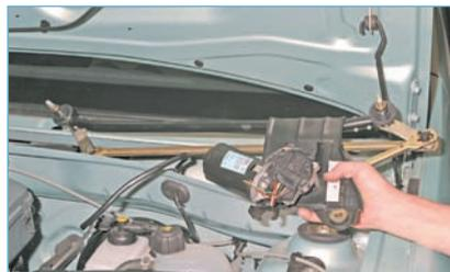
Снимаем очиститель ветрового стекла.
