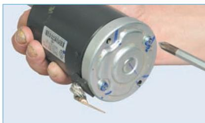
**...крестообразной отверткой отворачиваем два винта крепления крышки...**
