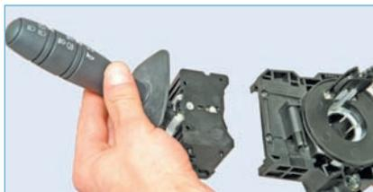
**Вынимаем левый подрулевой переключатель из соединителя.**
