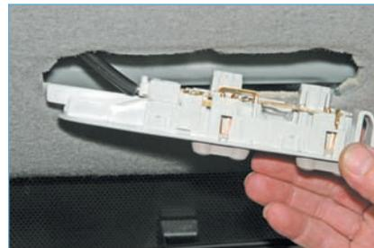
...вынимаем плафон из обивки потолка.
