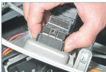
Сжав два фиксатора, выводим выключатель из отверстия накладки...
