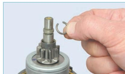
...вынимаем из канавки вала якоря стопорное кольцо.
