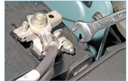
Ключом «на 10» ослабляем затяжку гайки стяжного болта клеммы проводов на «минусовом» выводе аккумуляторной батареи...
