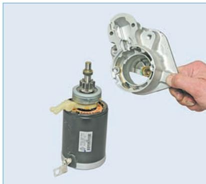
Снимаем переднюю крышку стартера.
