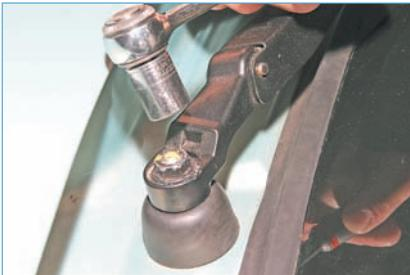
Головкой «на 13» отворачиваем гайку крепления рычага стеклоочистителя.
