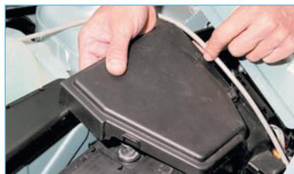
...и, сдвинув в направлении аккумуляторной батареи крышку, снимаем ее. Неисправный предохранитель определяем по перегоревшей перемычке. Для извлечения предохранителя малого размера...
