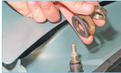
...и снимаем с вала мотор-редуктора гайку, шайбу и уплотнитель.
