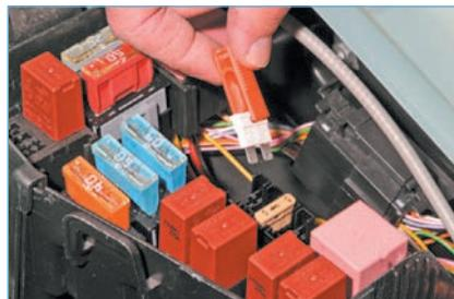
...используем пинцет-съемник, расположенный в крышке монтажного блока в салоне.
