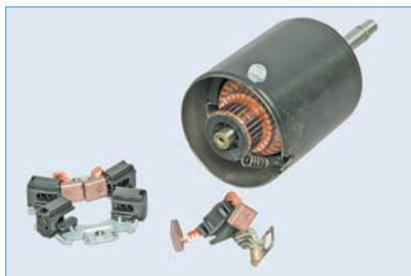
**Вынимаем щеточный узел, при этом из его направляющих могут выскользнуть щетки и пружины.**
