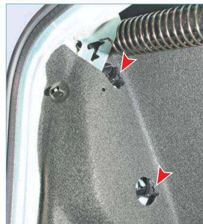
Отворачиваем внутри багажника две пластмассовые гайки крепления заднего фонаря.
