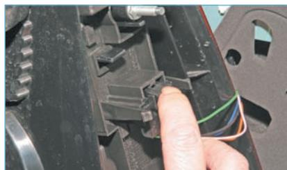
Нажав на фиксатор колодки проводов...
