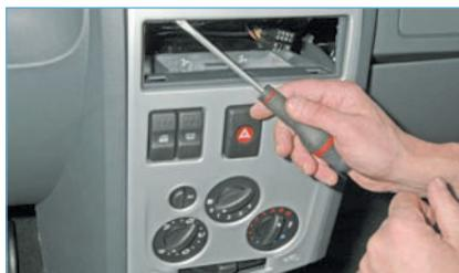
Отверткой отжимаем накладку консоли панели приборов и выводим из зацепления фиксаторы накладки.
