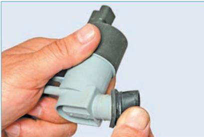
Снимаем уплотнительную втулку с патрубка насоса.
