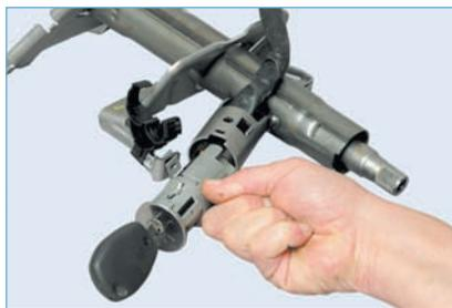
...и вынимаем его из гнезда рулевой колонки (для наглядности показано на снятой рулевой колонке). Устанавливаем выключатель зажигания и катушку иммобилайзера в обратной последовательности.
