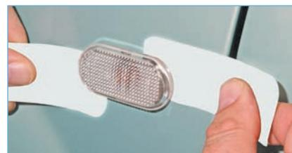
...вставляем две пластиковые пластины (можно использовать пластиковые карты) между крылом и указателем с обеих сторон и, сжав два фиксатора...
