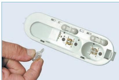
Вынимаем лампу освещения из плафона (для наглядности показано на снятом плафоне)...
