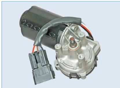
...и снимаем мотор-редуктор.
