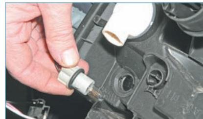
...и извлекаем патрон с лампой из корпуса блок-фары.
