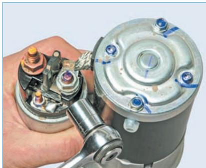
...головкой «на 13» отворачиваем гайку крепления наконечника провода щеточного узла к контактному болту тягового реле...
