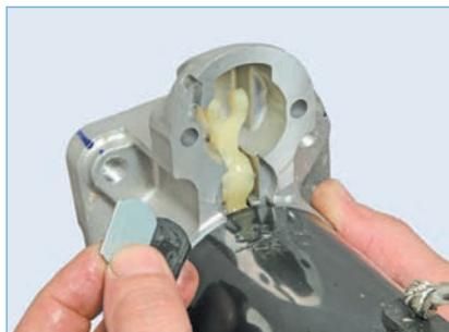
Снимаем опору и уплотнитель рычага привода.
