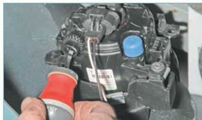
Шлицевой отверткой вращаем пластмассовый регулировочный винт по часовой стрелке — для подъема пучка света, или против часовой стрелки — для опускания пучка.
