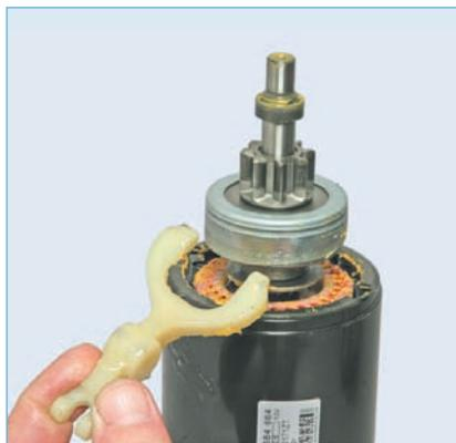
Снимаем рычаг привода.
