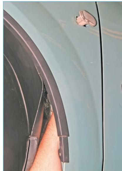
...выталкиваем указатель из отверстия крыла.
