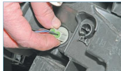
Поворачиваем патрон лампы габаритного света по часовой стрелке (для правой фары — против часовой стрелки)...
