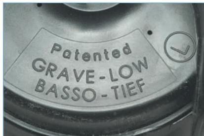
**Маркировка звукового сигнала низкого тона**
