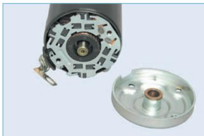
**...и снимаем крышку стартера.**
