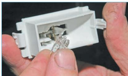
Вынимаем лампу из плафона.
