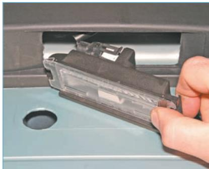
...и вынимаем фонарь из отверстия заднего бампера.
