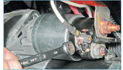
...накидным ключом или головкой «на 8» отворачиваем гайку крепления наконечника провода к управляющему выводу тягового реле...
