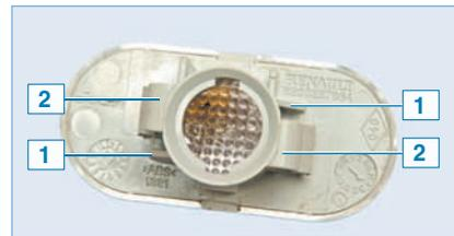
Рядом с фиксаторами 2 на корпусе указателя выполнены два выступа 1
