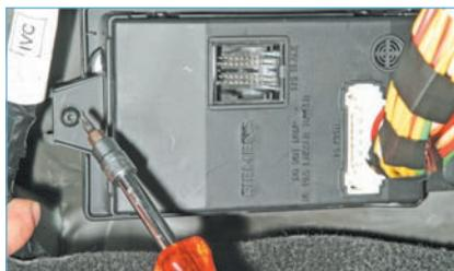
Ключом «Torx T-20» отворачиваем винт крепления блока...
