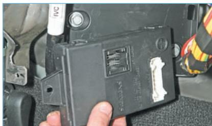
...и снимаем коммутационный блок.
