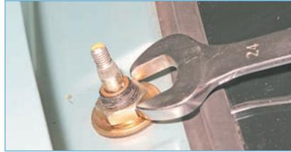
Ключом «на 24» отворачиваем гайку...
