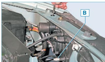
Для изменения направления светового пучка фары в вертикальной плоскости вращаем шестигранником «на 6» винт А (см. предыдущее фото), вставив шестигранник через отверстие в поперечине кузова. Для изменения направления светового пучка фары в горизонтальной плоскости вращаем ручку В.
