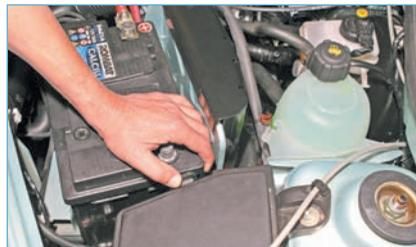
...отводим фиксатор крышки блока в сторону...
