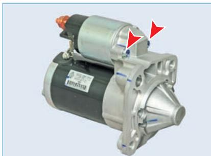
Крестообразной отверткой отворачиваем два винта крепления тягового реле...
