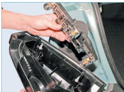
...и вынимаем из корпуса фонаря держатель с лампами.
