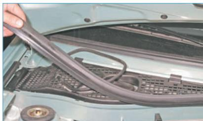
Снимаем уплотнитель с перегородки щитка передка.
