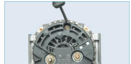
...крестообразной отверткой отворачиваем винт крепления кожуха генератора.
