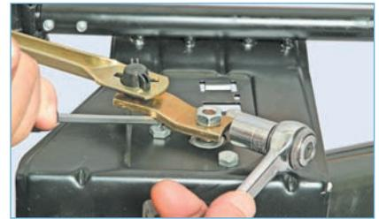
Головкой «на 13» отворачиваем гайку крепления кривошипа очистителя, удерживая кривошип отверткой.
