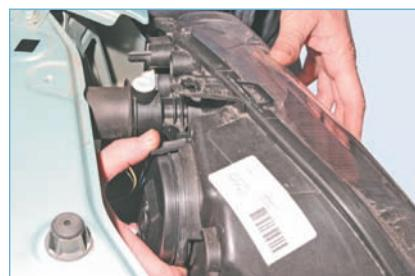
**...снимаем пластмассовую крышку (для наглядности болты крепления блок-фары отвинтуются и она выдвинута вперед).**
