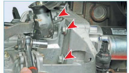
...головкой «на 13» отворачиваем три болта крепления стартера к картеру сцепления (для наглядности показано на снятом двигателе).
