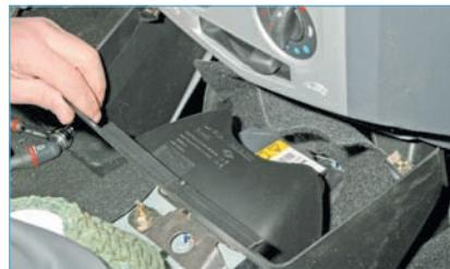
...снимаем нижнюю облицовку консоли панели приборов.
