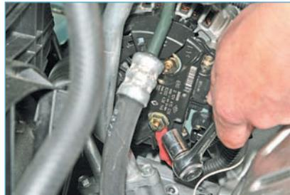
Головкой «на 13» отворачиваем гайку крепления наконечника «плюсового» провода к выводу «В2+» генератора...
