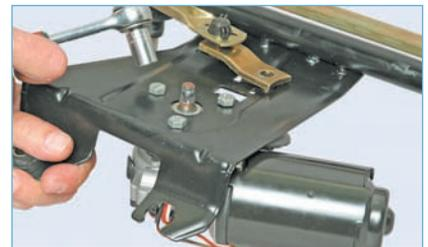
Головкой «на 10» отворачиваем три болта крепления мотор-редуктора к кронштейну очистителя...
