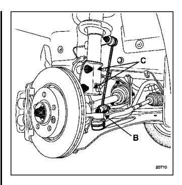
Извлеките хвостовик наружного шарнира приводного вала из поворотного кулака, наклонив его для этого.
