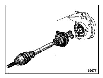
Приводной вал должен легко войти так, чтобы наружу вышла часть резьбы, на которую будет навинчена гайка ступицы.
