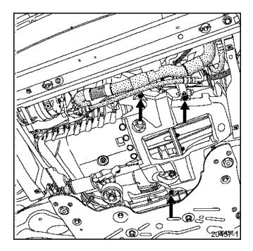
Отсоедините колодки проводов от электровентилятора системы охлаждения двигателя.
