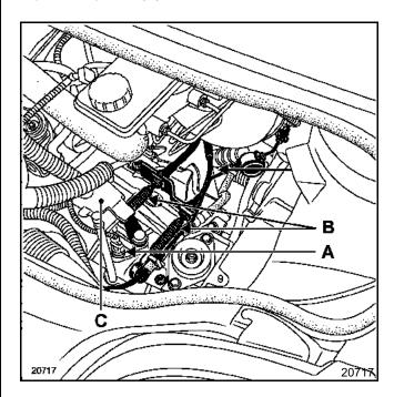
Привяжите жгуты проводов, чтобы облегчить снятие коробки передач.
