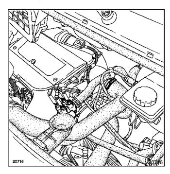
С помощью шприца удалите тормозную жидкость из бачка до штуцера трубопровода главного цилиндра привода сцепления.
