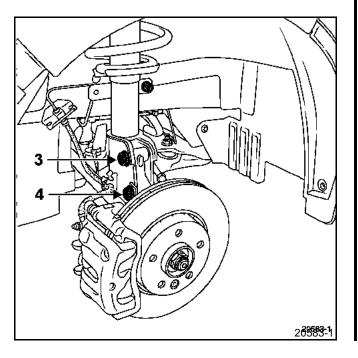
Снимите фланец промежуточной опоры.
