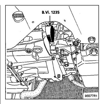
Расположите приводной вал перед полуосевой шестерней.
