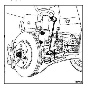
шаровые опоры рычагов подвески. Если гайка не отворачивается, используйте торцевой шестигранный ключ, отрезанный под размер X.
