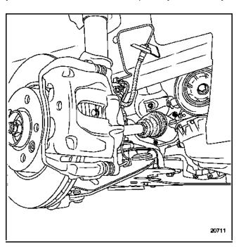
**ПРИМЕЧАНИЕ**: при каждом снятии вала привода правого переднего колеса рекомендуется заменять уплотнительную манжету фланца дифференциала.
