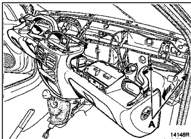
Снимите блок испарителя.
