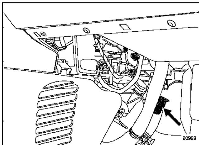
Датчик испарителя показывает температуру на выходе из испарителя.
