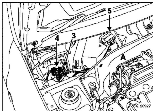
**ПРИМЕЧАНИЕ:** чтобы извлечь блок испарителя с автомобилей с двигателями **К9К**, необходимо предварительно снять корпус воздушного фильтра.
