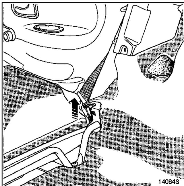
Извлеките ось крепления спинки заднего сиденья из гнезда на боковине кузова.
