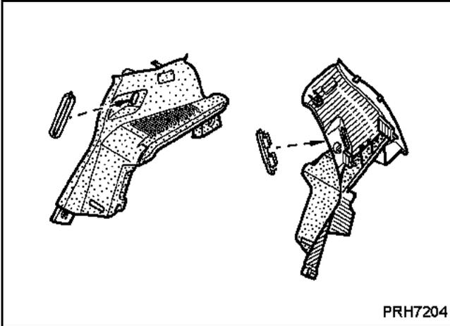
Отсоедините фонарь освещения багажного отделения, а также концевой выключатель (с левой стороны).
