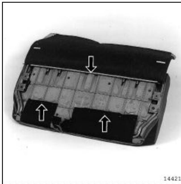
Удалите **двойные фиксаторы**, установленные на каркасе.
