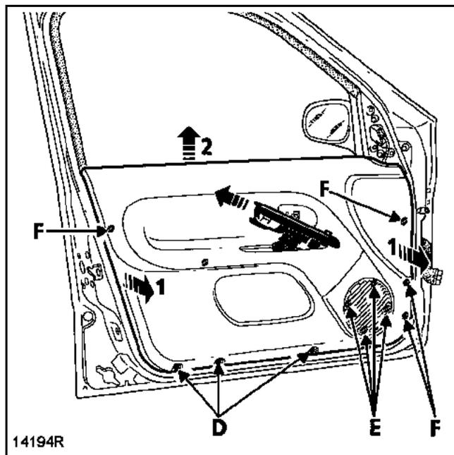
Отверните болт крепления внутренней ручки двери.
