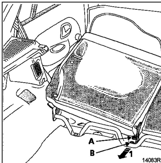
Выверните болт крепления центральной вилки (А) и снимите вилку (1) с удерживающего выступа (В), закрепленного на полу.
