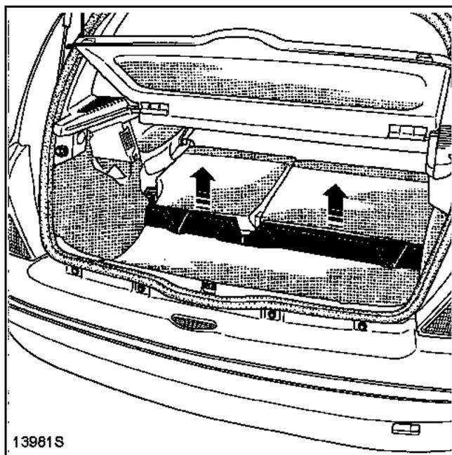
Снимите облицовку усилительной поперечины багажника.
