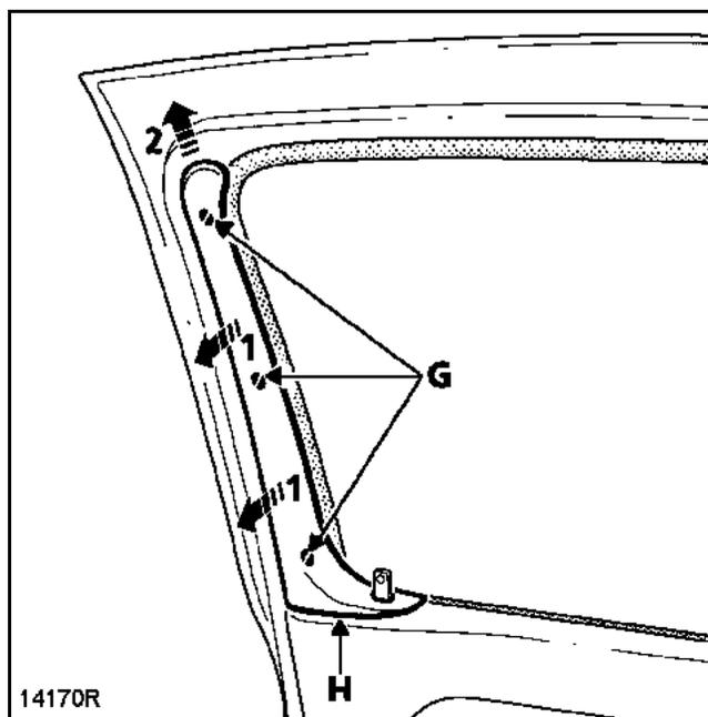
Перед тем, как снимать обивку двери, снимите держатели облицовки (1) стойки двери (G) и приподнимите ее (2), чтобы отжать пружинные защелки (H).
