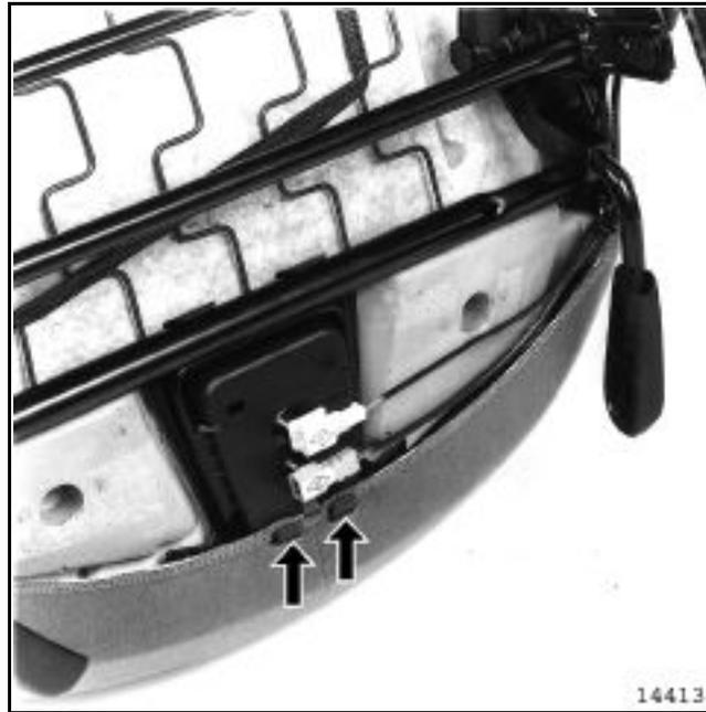
Снимите нижнюю часть обивки в передней части сиденья с двух пластмассовых захватов держателя разъемов.
