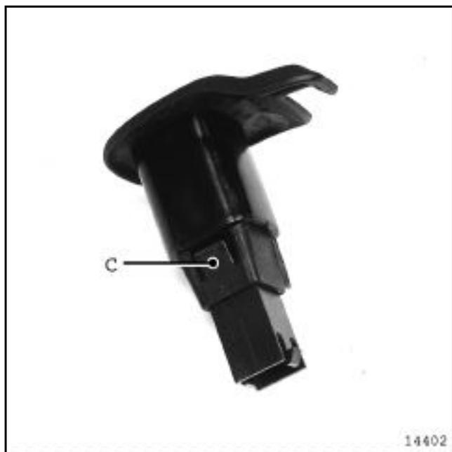
Защелки (С) направляющих на каркасе спинки.
