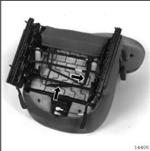
Снимите два ремня фиксации обивки на металлической сетке каркаса сиденья.
