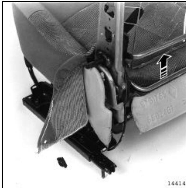
Извлеките боковины обивки в задней части сиденья из гнезда на каркасе сиденья.
