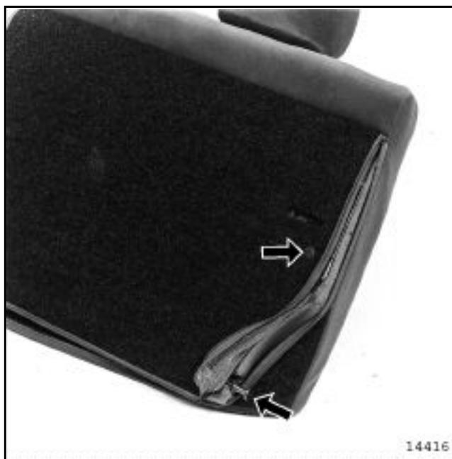
Снимите набивку с боковой поперечины.
