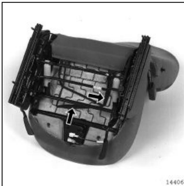
Удалите два ремня фиксации обивки на металлической сетке каркаса сиденья.
