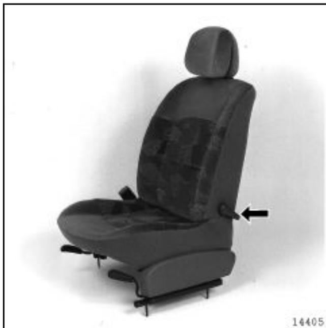
Снимите ручку регулировки наклона спинки сиденья (если она есть), действуя так же, как и в случае с ручкой регулировки поясничного подпора спинки сиденья.
