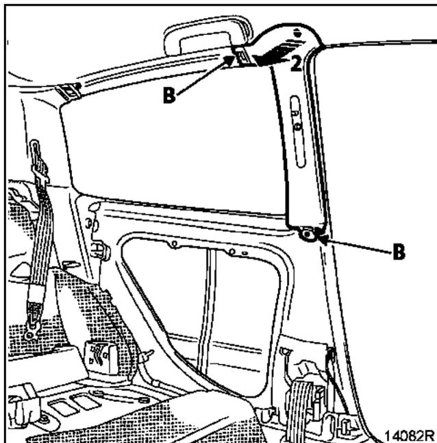
Отверните два крепежных винта (B).
