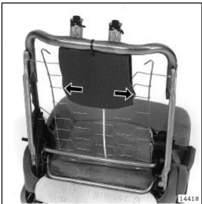
Снимите два фиксатора защитной тканевой прокладки.
