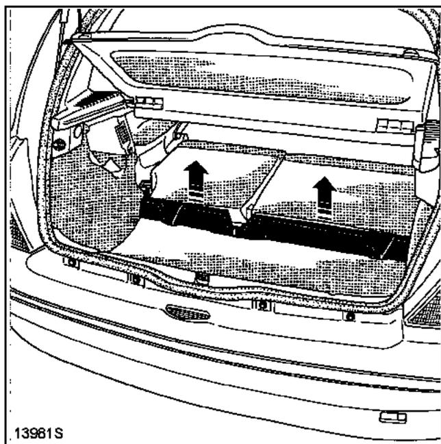
Снимите облицовку усилительной поперечины багажника.
