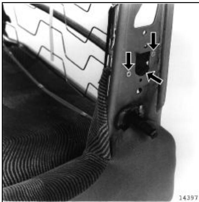
**СНЯТИЕ КОРПУСА (E) И ТРОСА ПРИВОДА СТОПОРА СИДЕНЬЯ**
