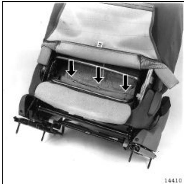
Снимите три **двойных фиксатора**, крепящих набивку спинки сиденья из пеноматериала на металлическом каркасе.
