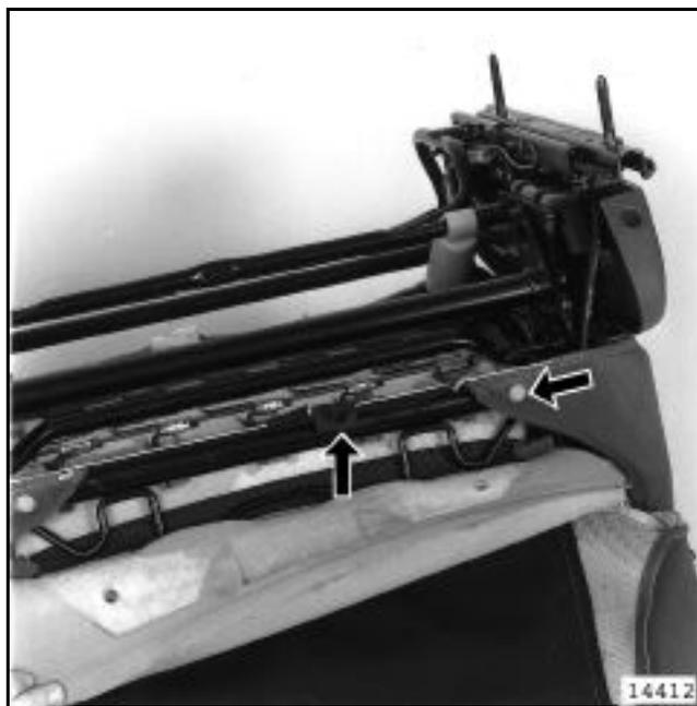
При помощи щипцов для снятия держателей обивок и облицовок снимите фиксаторы обивки с задней части сиденья.
