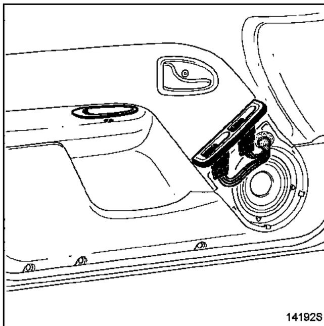
**ПРИМЕЧАНИЕ:** на модификации E для получения доступа к разъемам электродвигателей привода наружных зеркал заднего вида, достаточно снять только решетку громкоговорителя.
