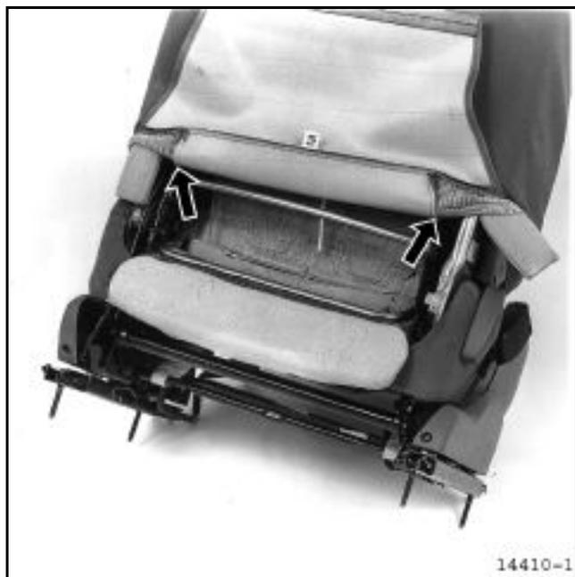
Оттяните удерживающую ленту задней части обивки спинки сиденья, чтобы получить доступ к **двойному фиксатору**, закрепляющему две стороны обивки подушки сиденья (см. следующую иллюстрацию).
