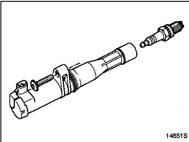
Катушки зажигания (четыре, по числу цилиндров) фиксируются прямо на свече с помощью болта на крышке головки блока цилиндров.
