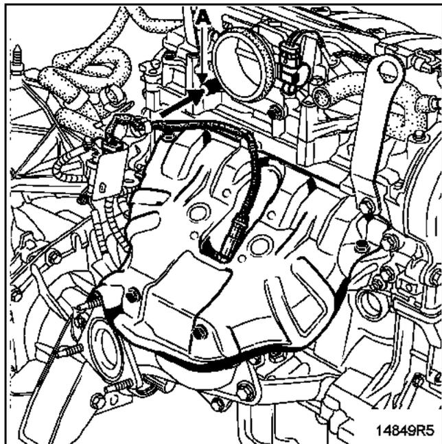
Маслоотделитель расположен на крышке головки блока цилиндров.
