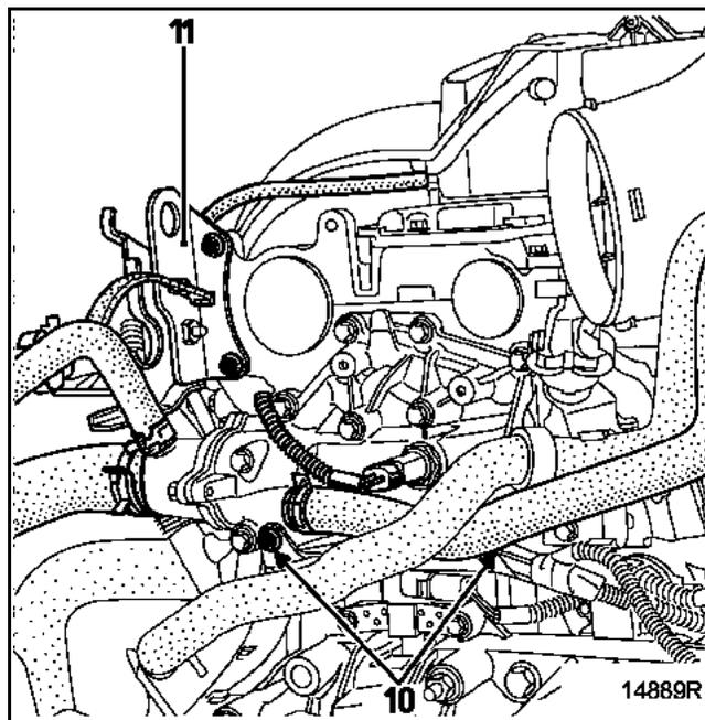
Снимите головку блока цилиндров.
