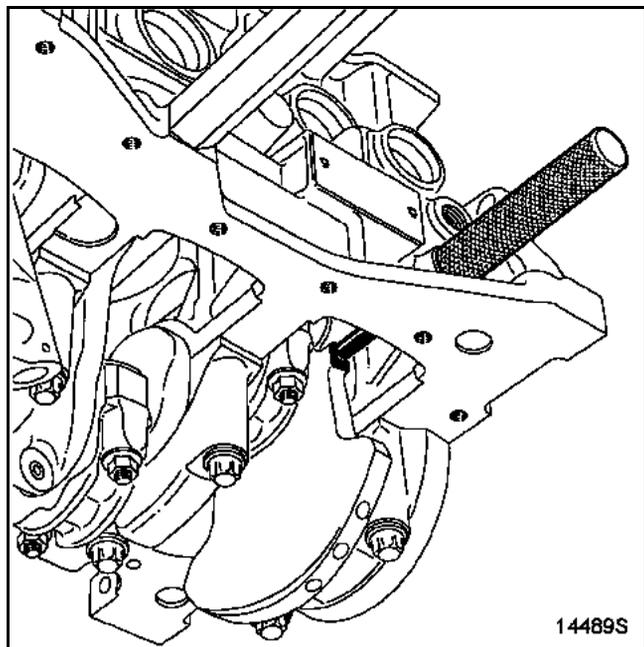
Затяните болт крепления шкива коленчатого вала моментом **2 даН.м**, затем поверните на  $135^\circ \pm 15^\circ$  (при этом коленчатый вал должен быть заблокирован фиксатором верхней мертвой точки).
