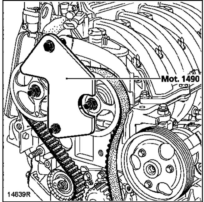
При установке натяжного ролика следите за тем, чтобы выступ ролика должным образом вошел в паз (А).
