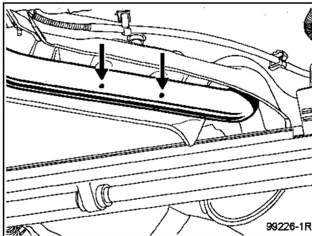
На выпускном трубопроводе имеется зона резки, расположенная между передним глушителем и основным глушителем.
