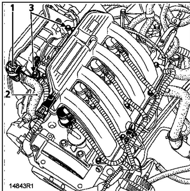
Сдвиньте корпус воздушного фильтра вправо, чтобы извлечь его. Корпус воздушного фильтра может пройти между проемом ветрового окна, двигателем и вакуумным усилителем тормозов.
