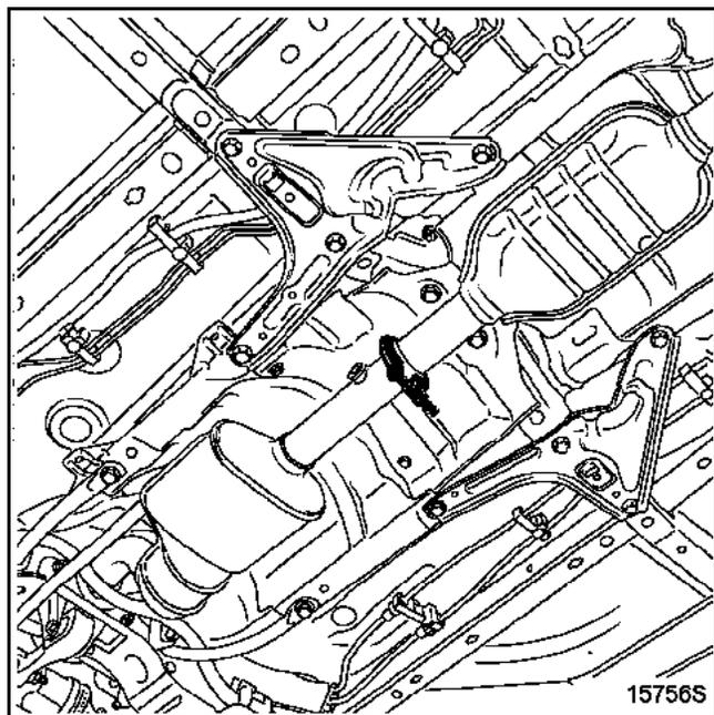
Отсоедините каталитический нейтрализатор от трубы основного глушителя.
