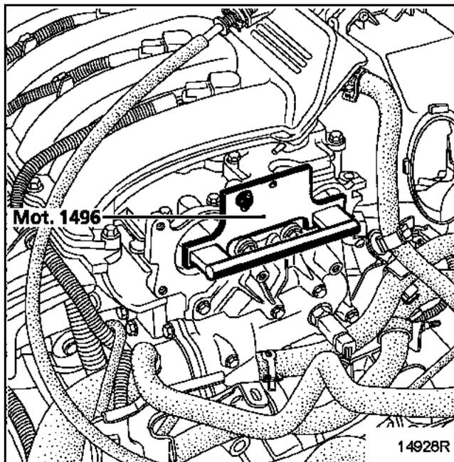
Установите зубчатые шкивы распределительных валов, наживив новые крепежные гайки (**оставьте зазор между гайкой и зубчатым шкивом 0,5 - 1 мм**).
