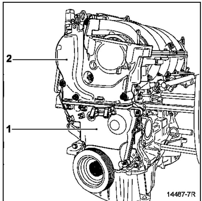
Ослабьте ремень привода газораспределительного механизма, отвернув гайку (1) крепления оси натяжного ролика.
