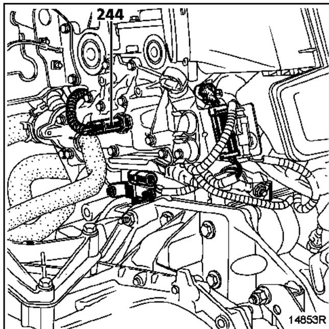
**244** Датчик температуры охлаждающей жидкости (выдает информацию на ЭБУ системы впрыска и указатель температуры охлаждающей жидкости на щитке приборов).
