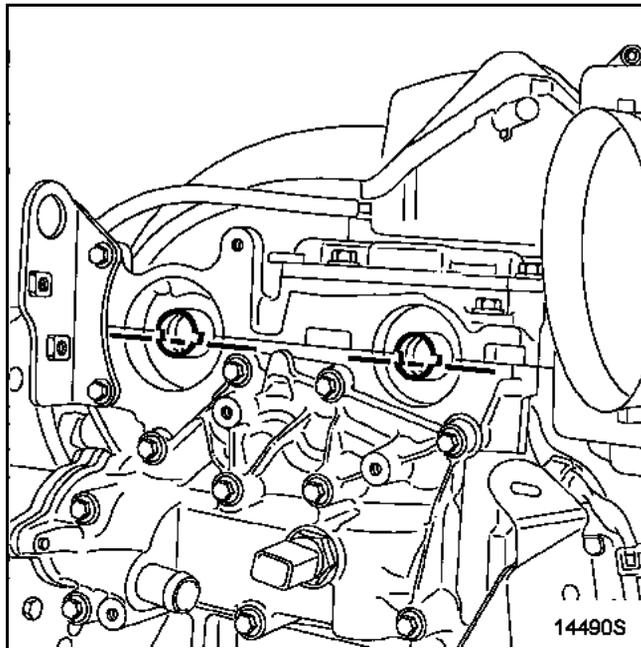
Зафиксируйте приспособление Mot. 1496 на концах распределительных валов.
