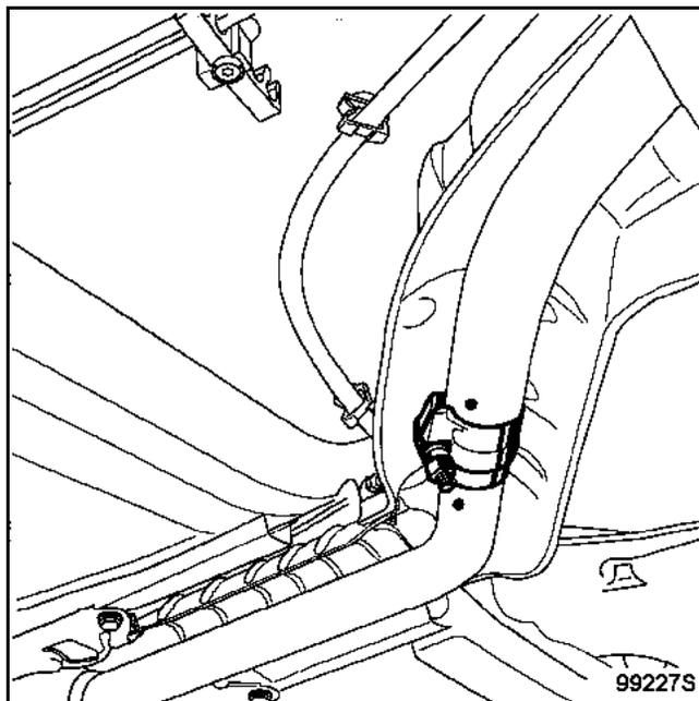
Гайка муфты имеет канавку (А), которая служит для определения правильности момента затяжки. В процессе затяжки, когда эта канавка исчезает, раздается характерный щелчок. Это означает, что гайка завернута требуемым моментом (**2,5 даН.м**).
