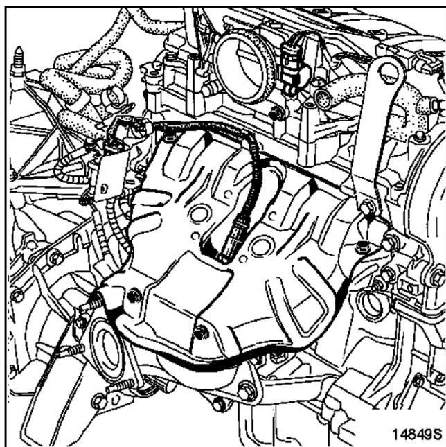
Отсоедините колодку проводов и снимите кислородный датчик с помощью приспособления Mot. 1495.
