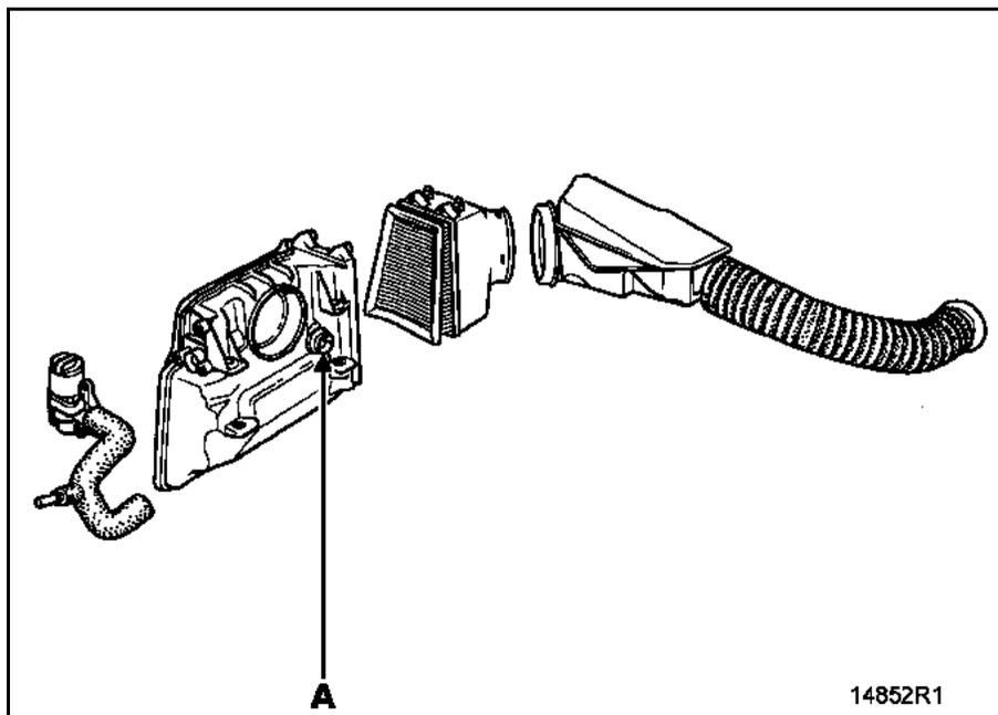
Выходное отверстие системы вентиляции картера.
