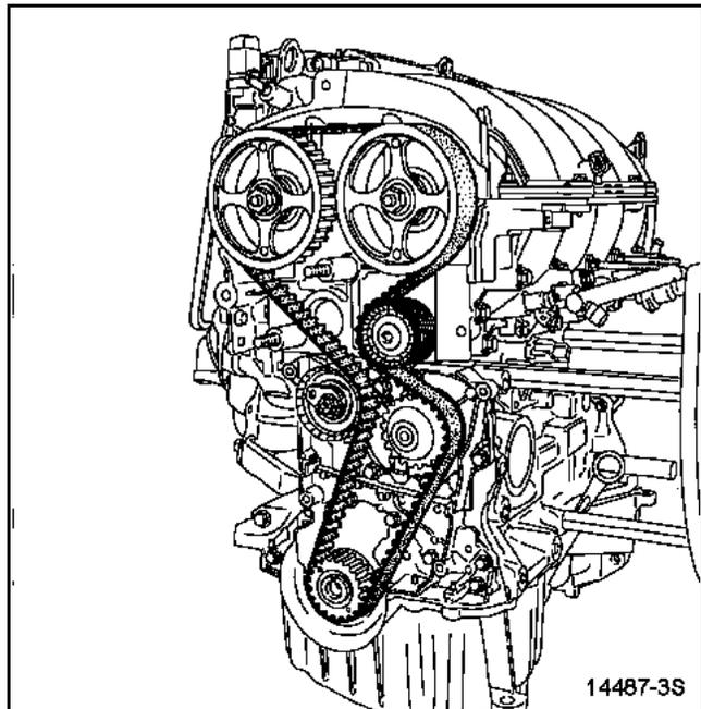
Установите шкив коленчатого вала, предварительно затянув болт (**не затягивайте болт окончательно, зазор между болтом и шкивом должен составлять 2 - 3 мм**).
