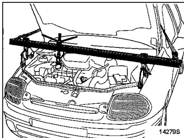
**ПРИМЕЧАНИЕ:** в ходе операции следите за тем, чтобы установочные лапы опорной перекладины для вывешивания двигателя были установлены на жестких частях крыльев.
