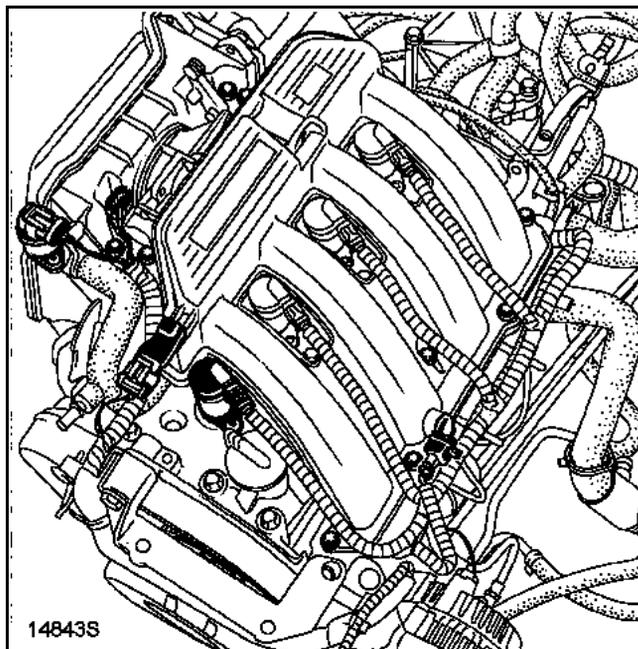
Установка выполняется в порядке, обратном снятию, при установке соблюдайте моменты затяжки трех болтов крепления. Проверьте состояние и убедитесь в правильной установке уплотнительного кольца.
