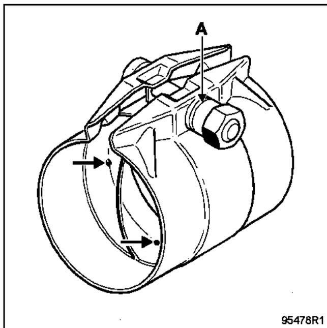
Чтобы избежать утечки отработавших газов, необходимо правильно установить муфту на обеих частях выпускной трубы. Это означает, что труба должна дойти до упора в выступы внутри муфты.
