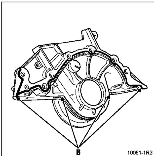
Установите поддон картера с новой прокладкой, предварительно выполнив усадку прокладки, затягивая болты крепления поддона моментом **0,8 даН.м**, после чего окончательно затяните болты ("крест-накрест") моментом **1,4 даН.м**.
