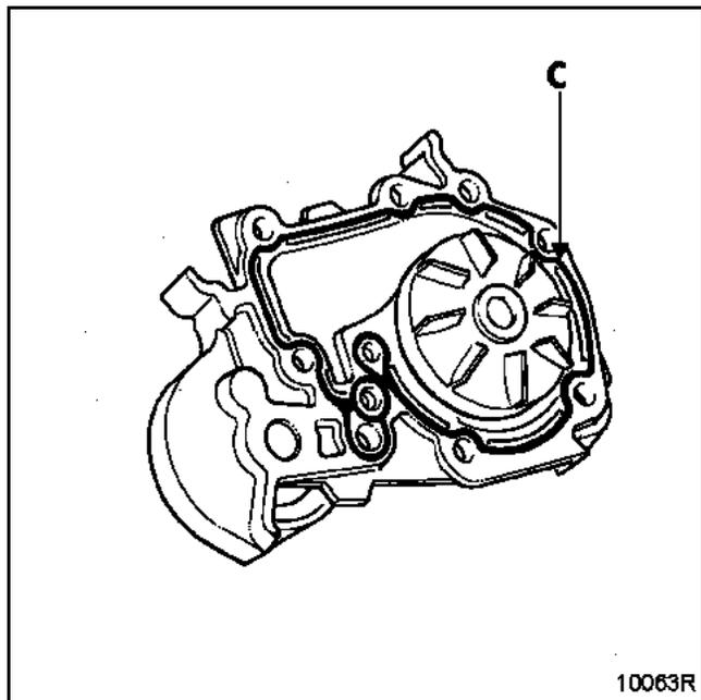
Предварительно затяните болты **M6** и **M8** моментом **0,8 даН.м** затем затяните моментом **1,1 даН.м** болты **M6** и моментом **2,2 даН.м** болты **M8** в указанном порядке.
