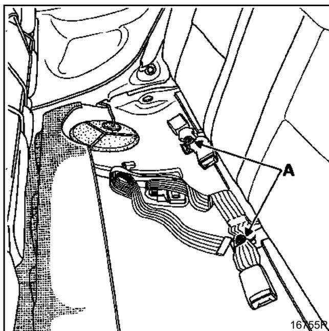
Снимите два болта крепления каркаса спинки сиденья (А).
