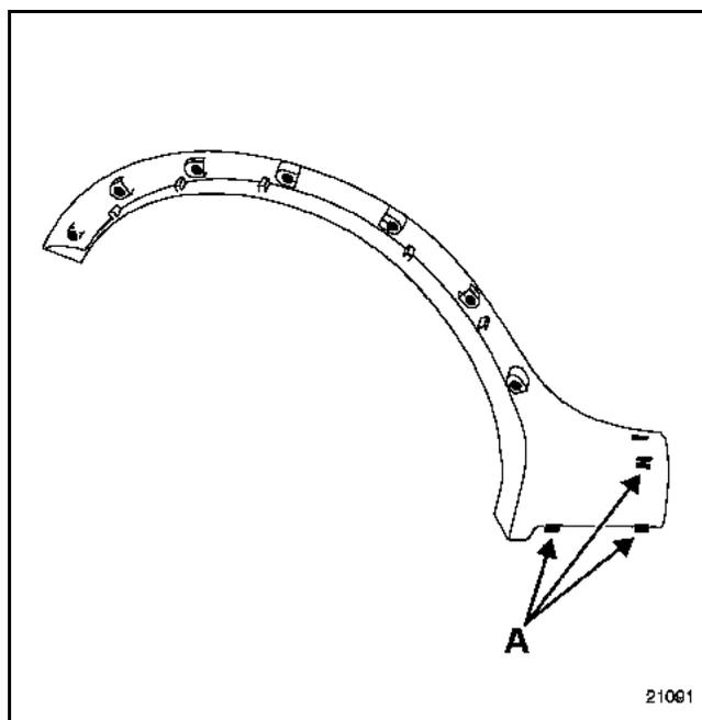
Снимите три пружинные держатели (А), затем снимите расширитель.
