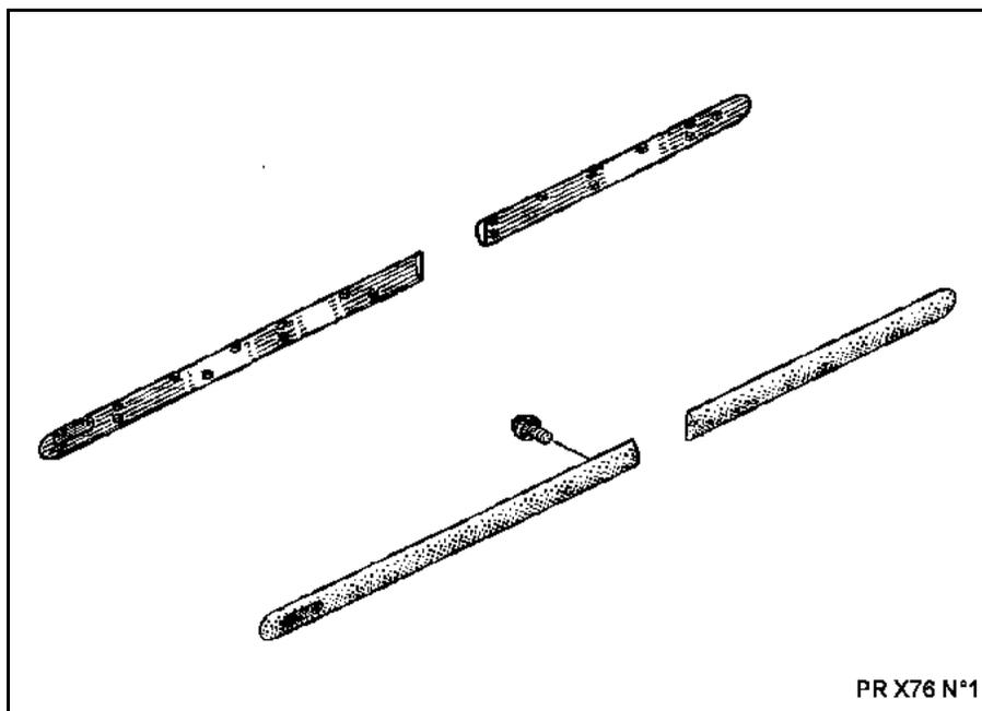
СНЯТИЕ ЗАЩИТНОЙ НАКЛАДКИ С ПЕРЕДНЕЙ ДВЕРИ
