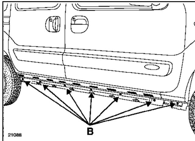
Отверните гайки (B), затем снимите кронштейны нижней секции боковины кузова.
