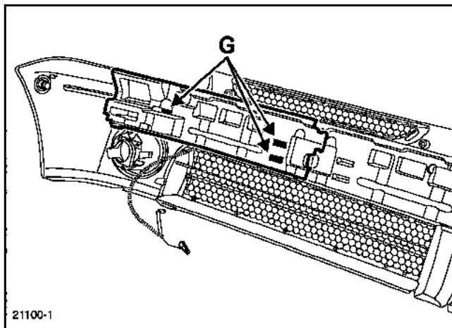
Снимите пружинные держатели (G), затем снимите демпфер.
