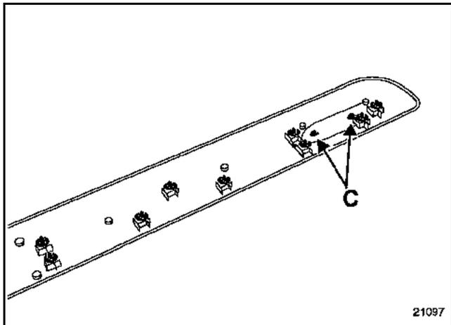
Снимите оба пружинных держателя (С), затем снимите надпись.
